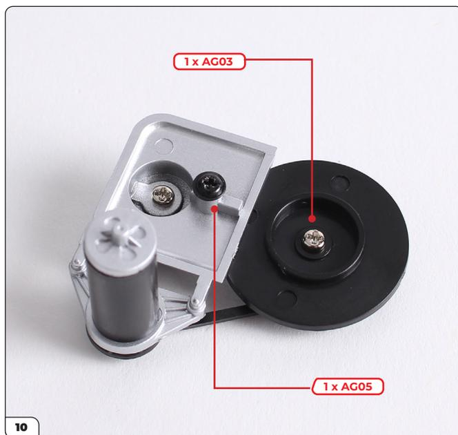
Monta la grande puleggia tra la cinghia del ventilatore e il coperchio, fissandola con una vite AG03. Monta una vite AG05 nel foro rimanente nel coperchio della catena di distribuzione.
