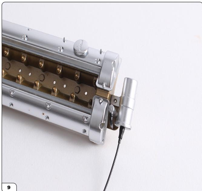
Questo mostra il respiratore del motore correttamente montato.
