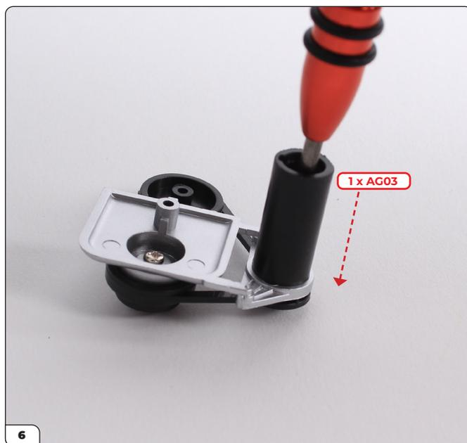
Inserisci una vite AG03 attraverso il corpo del dinamo e stringila per fissare il dinamo in posizione.
