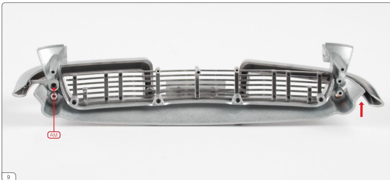
フロントボディパネルとフロントバンパーが、所定の位置に配置された状態です。フロントバンパーブラケット (L) とフロントボディパネルをAMネジで固定します。フロントバンパー (R) とフロントボディパネルは、次の工程で固定します。
