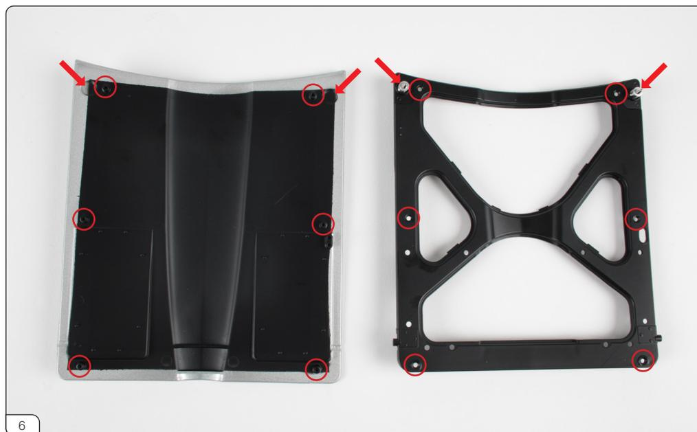
ステージ②で開梱したフードを裏返して置きます。塗装を傷付けないように、柔らかい布などの上で作業してください。ラッチピンの円錐形の端が上を向くように、フードラインフォースメントをフードに合わせます。6つの赤丸印のネジ穴を合わせて、フードラインフォースメントを配置します。
