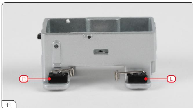
フューエルインジェクションユニットハウジングの反対側にも、左右の燃料噴射ノズルを取り付けます。
