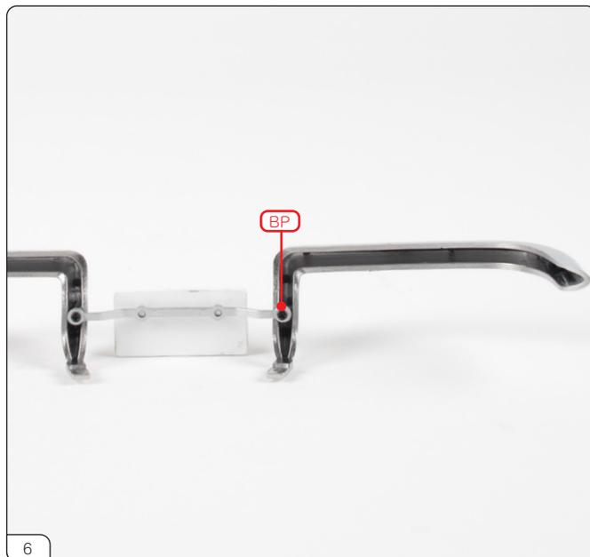
同様の手順で、フロントバンパー (R) にナンバープレートブラケットをBPネジで固定します。
