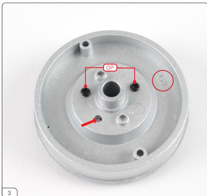
アウターホイールリムを裏返して、「3」 (赤丸印) が画像の位置になるように配置します。DPネジ (2本) でパーツを固定します。赤矢印のネジ穴は、フリーの状態にしておきます。
