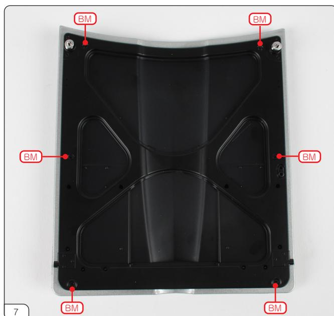
フードラインフォースメントをフードにはめ込み、BMネジ（6本）で固定します。固定するには各コーナーを緩めに締めて、フードラインフォースメントが所定の位置に収まったのを確認して、6本のネジを軽く締め増ししてください。
