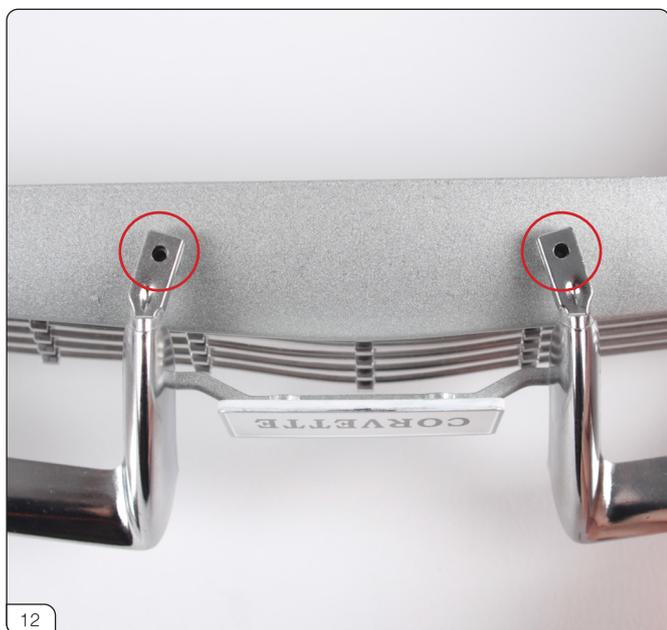
フロントボディパネルを裏返して、フロントバンパーのタブをフロントボディパネル裏側のネジ穴に合わせます (赤丸印)。
