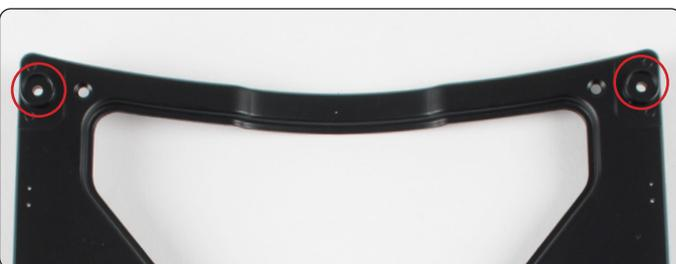
画像のようにフードインフォースメントを置き、組み立てたラッチを外側両サイドの穴(上写真の赤丸印)に差し込みます。
