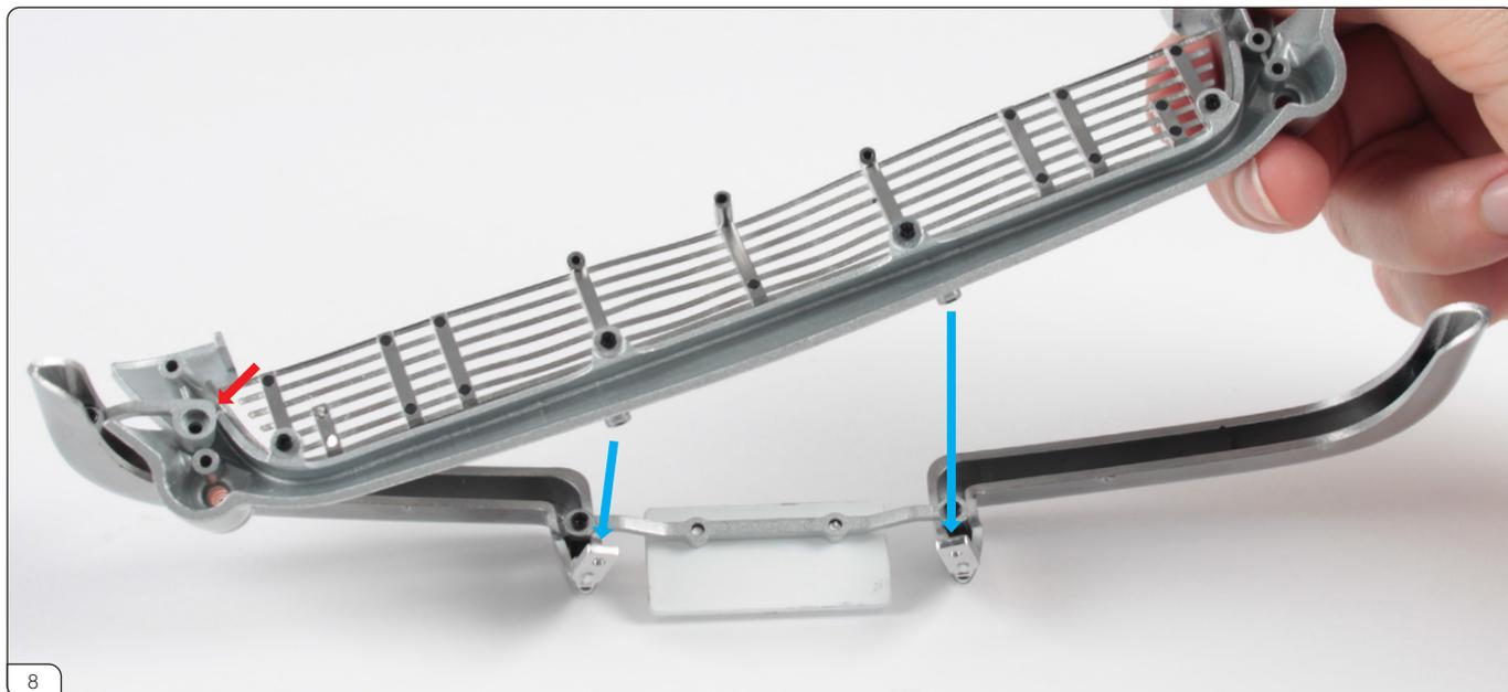
フロントボディパネルの穴とフロントバンパーブラケット (L) のネジ穴を合わせます (赤矢印)。左右のフロントバンパーから出ているタブの上に、フロントボディパネル裏側の2つのネジ穴を合わせます (青矢印)。
