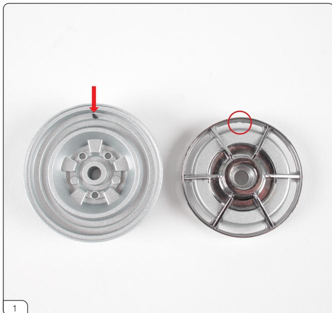
アウターホイールリムのエアバルブ (赤矢印) と6本スポークホイールカバーの半月形の切り欠き (赤丸印) を確認します。
