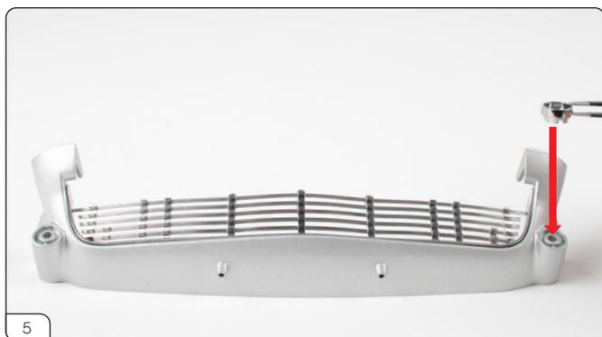
画像のようにインジケータハウジングの1つを、ボディパネル左側の凹部に合わせます (赤矢印)。
