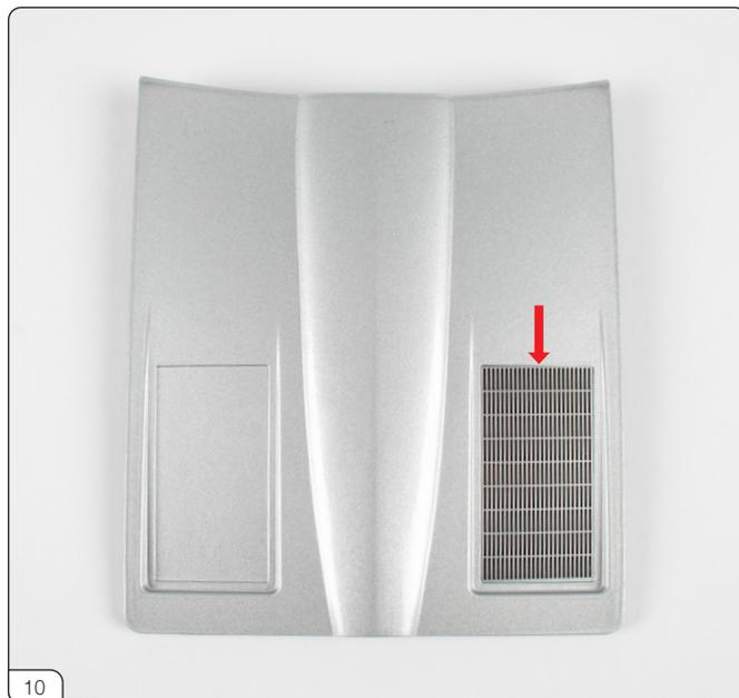
ベントシールをフードの凹部に合わせて貼り付けます。上部分（赤矢印）を決めて、左右が揃うように慎重に貼っていきます。
