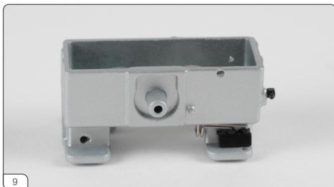
左の燃料噴射ノズルを、フューエルインジェクションユニットハウジングの穴に押し込みます。
