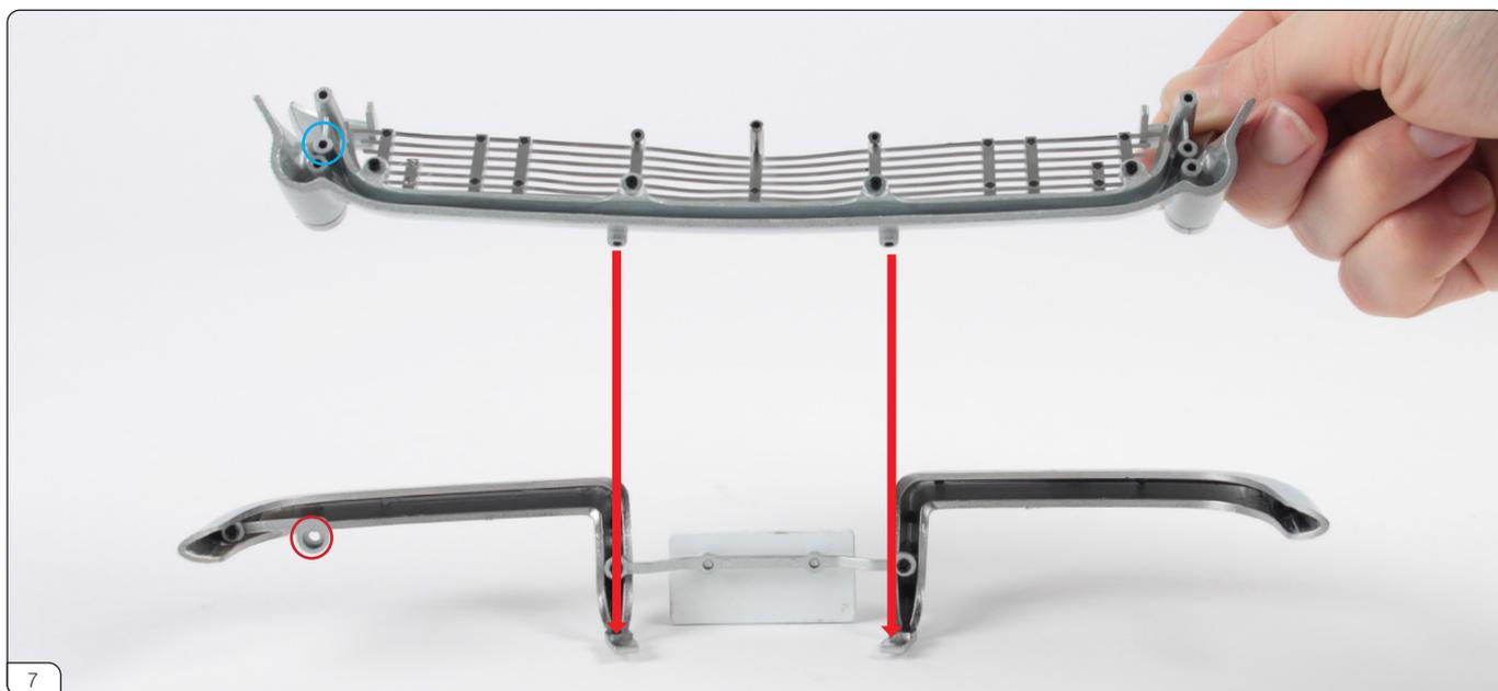
画像のように、ステージ①で組み立てたフロントボディパネル裏側の2つのネジ穴は、左右のフロントバンパーから出ているタブの上に配置します (赤矢印)。フロントボディパネルの青丸印は、フロントバンパーブラケット (L) の赤丸印にはめ込まれます。
