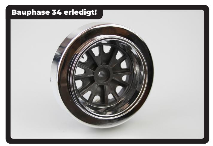
In Bauphase 35 bauen Sie weiter am linken Hinterrad. Sie bauen jetzt den Reifen an und befestigen ihn an der Radnabe.
