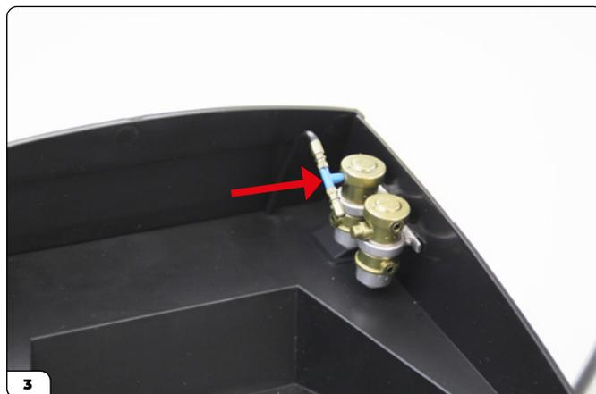
Introduce la clavija azul del tubo de la bomba de combustible 2 en el orificio inferior de la bomba de combustible 1.
