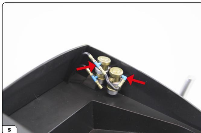
Empuja la clavija azul del tubo de la bomba de combustible 4 en el orificio inferior de la bomba de combustible 2. Introduce el extremo libre del tubo 4 en el extremo del tubo de la bomba de combustible 2.
