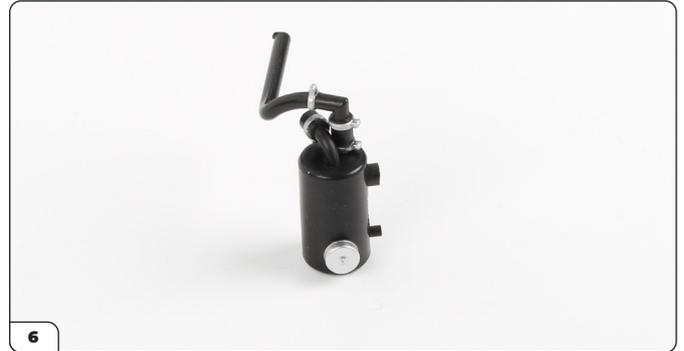
Um das Ölfiltergehäuse an der Spritzwand anzubringen, richten Sie das erhöhte Schraubloch und den Stift am Gehäuse auf die beiden Löcher in der Spritzwand aus. Stecken Sie das Ölfiltergehäuse hinein und verschrauben Sie es von der anderen Seite mit einer OP07-Schraube.
