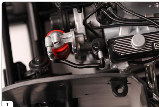
Toma el tubo 99c e inserta un extremo en el orificio que se encuentra en la tapa del volante, como se muestra en la imagen. De momento, deja el extremo superior del tubo 99c sin conectar.
