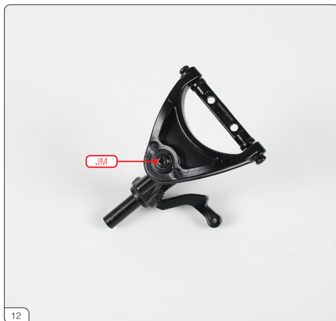
左コントロールアームをJMネジで固定します。
