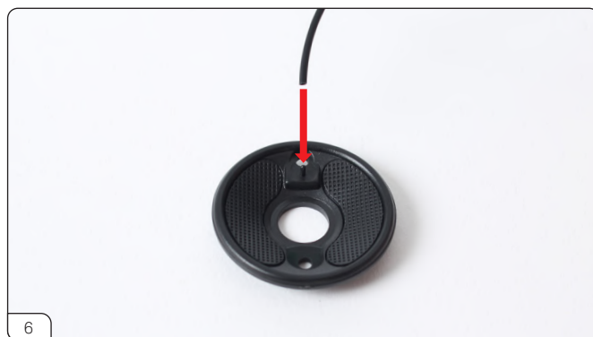
エアスcoop (L1) をカバーにはめ込み、ブレーキホースを取り付けます。
