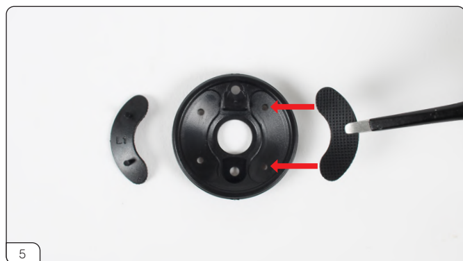
エアスcoop (L2) をドラムダストカバーにはめ込みます (赤矢印)。
