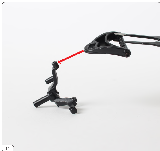
左サスペンションアップライトに左コントロールアームを合わせます。
