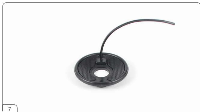
小さな突起にブレーキホースを差し込みます。
