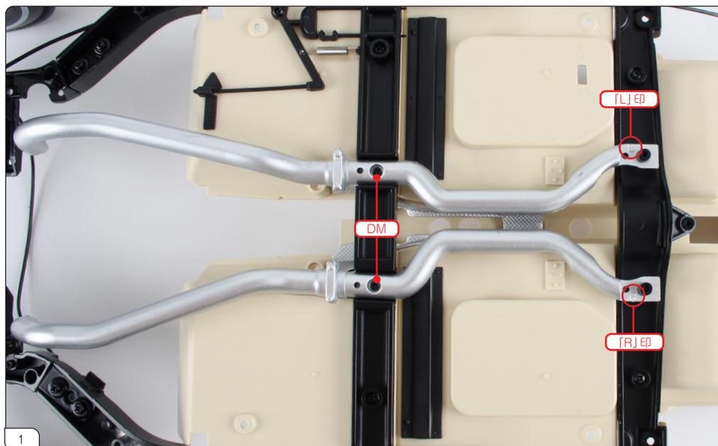
エキゾーストパイプには「L」と「R」の印が付いています(赤丸印)。左右のエキゾーストパイプを画像のようにシャーシフレームに配置し、DMネジ2本で固定します。
