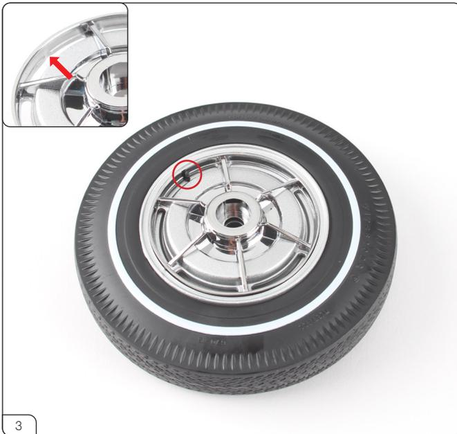
再びアセンブリーを裏返して、6本スポークホイールカバーを押し込みます。このとき6本スポークホイールカバーの凹み(左上小写真/赤矢印)をエアバルブ(赤丸印)に合わせてください。
