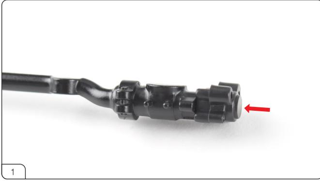
画像のように、ステアリングモーターをステアリングバーの端に押し込みます (赤矢印)。
