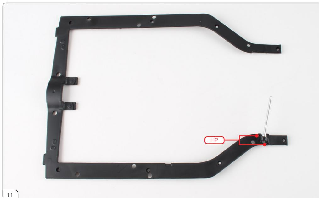
画像のようにシリンダーブラケットをシャーシカバーにセットし、HPネジ2本で固定します。
