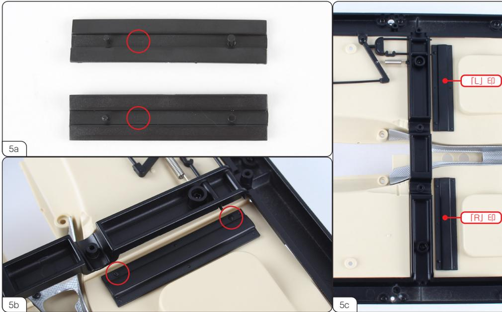
シャーシインフォースメントには、左右を区別するために「L」と「R」印が付いています（5a／赤丸印）。シャーシインフォースメントを取り付ける際は、ボルトがフレームのクロスビームの横にあることを確認してください（5b／赤丸印）。左右のシャーシインフォースメントを押し込みます（5c）。
