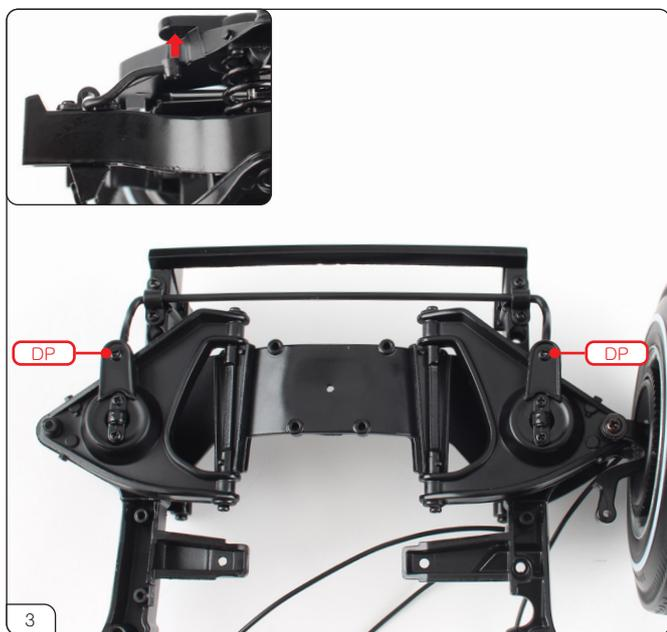
アンチロールバーの端を、ロアコントロールアームの穴まで持ち上げます (左上小写真／赤矢印)。アンチロールバーをDPネジ2本で固定します。
