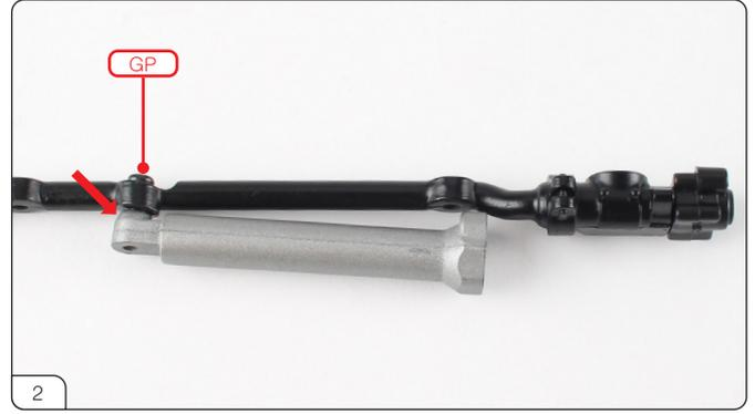
シリンダーをステアリングバーに配置します。シリンダーのネジ穴は、丸い部分をステアリングバーに向けてセットしてください (赤矢印)。ステアリングバーの側からGPネジで固定します。
