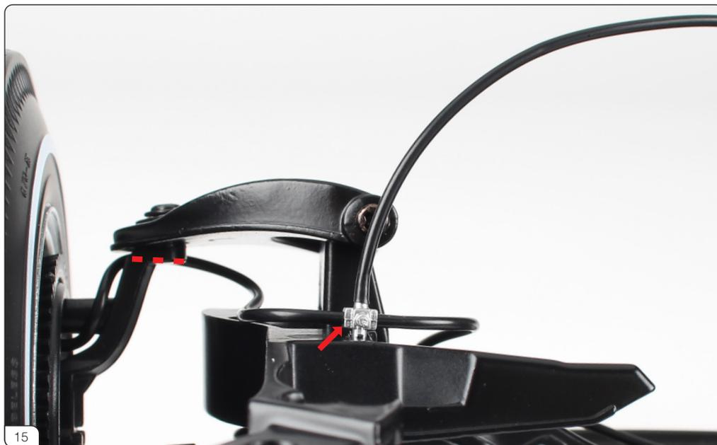
左ホイールのブレーキホースの自由端を、左サスペンションアップライトのうしろに通し（赤破線）、バイパスに取り付けます（赤矢印）。
