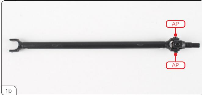
カルダンジョイントをトランスミッションシャフトのコネクターにセットし、APネジ2本で固定します (1a)。続いてこのカルダンジョイントを、トランスミッションシャフトの端にセットし、APネジ2本で固定します (1b)。
