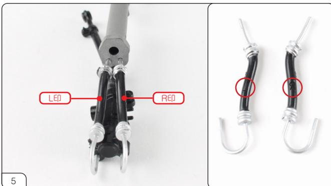
画像のようにホースの端を、シリンダーとステアリングモーターの穴に押し込みます。ホースの「L」と「R」 (赤丸印) に注意してください。
