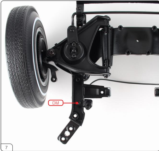
画像のように、リンケージブラケットをフロントシャーシの凹部にはめ込み、DMネジで固定します。
