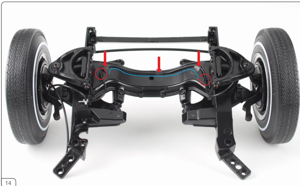
ブレーキホースをクリップ (赤丸印) に押し込み、画像のように引き回します (青線)。これを3枚の粘着テープで固定してください (赤矢印)。
