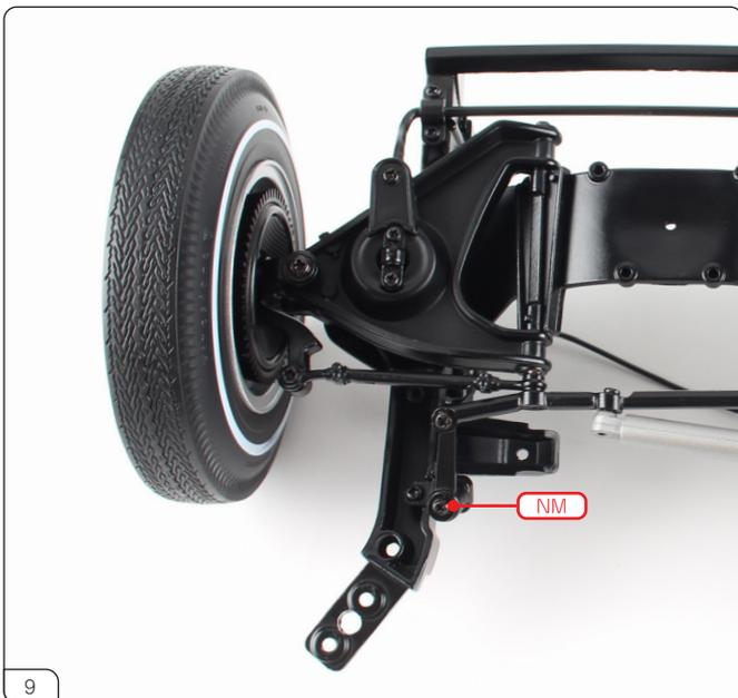
アイドラーアームの端を、NMネジでリンケージブラケットに固定します。
