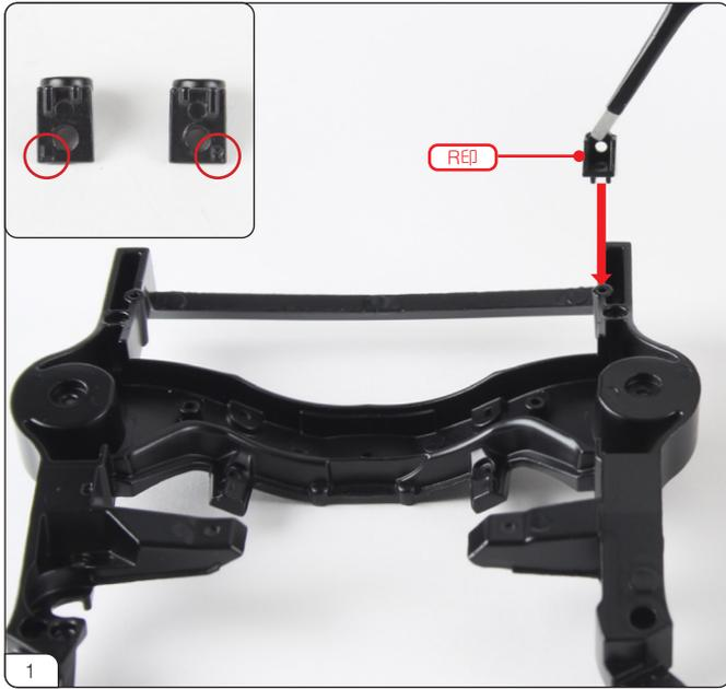
左右を区別するためにブラケットには、「R」「L」印が付いています（左上写真／赤丸印）。まず、右ブラケットをフロントシャーシに配置します（赤矢印）。
