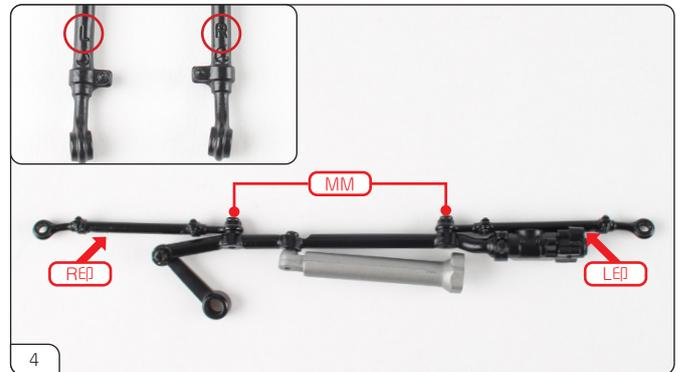
「R」「L」印 (左上小写真/赤丸印) が赤矢印の位置に向くようにセットします。MMネジ2本で、ステアリングリンケージをステアリングバーに固定します。
