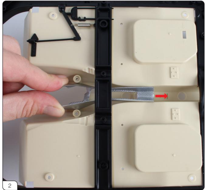
断熱シールドを取り付けます。幅の広い端を慎重に絞り、画像のようにクロスビームの下に押し込みます (赤矢印)。
