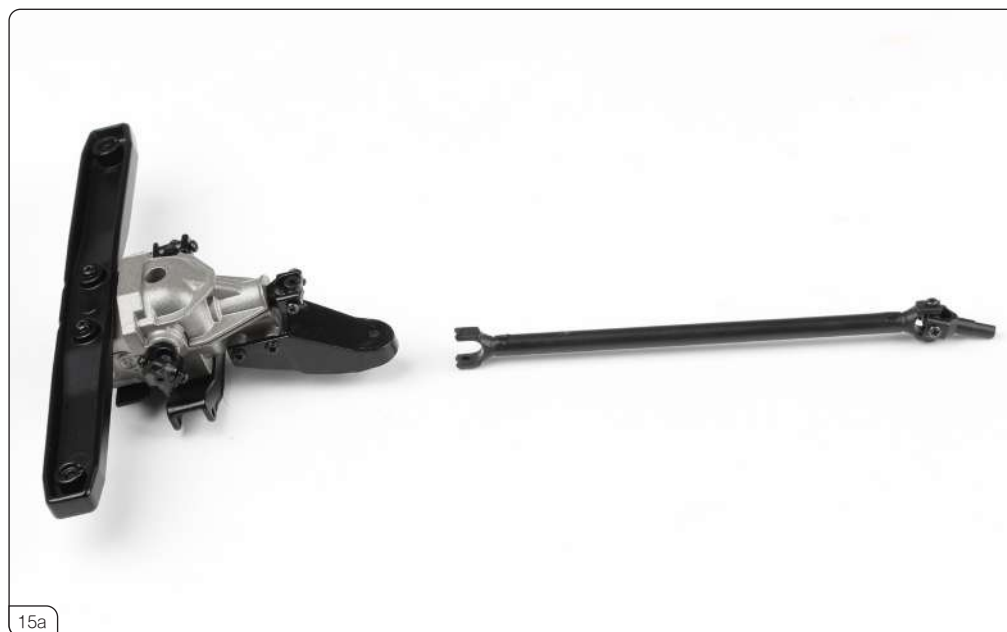
ステージ⑨で組み立てたトランスミッションシャフトをリアディファレンシャルケースに合わせます(15a)。コネクターを中央のジョイントに取り付け(15b／赤矢印)、APネジ2本で固定します(15c)。
