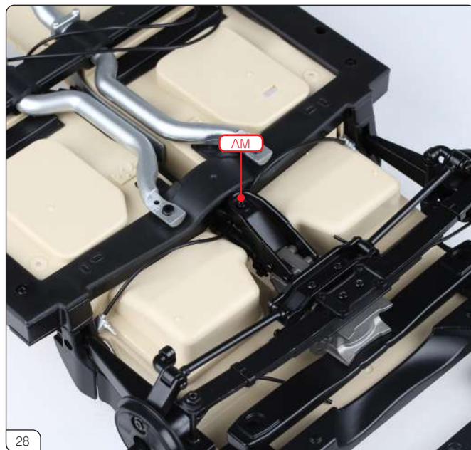
サポートブラケットをAMネジで固定します。
