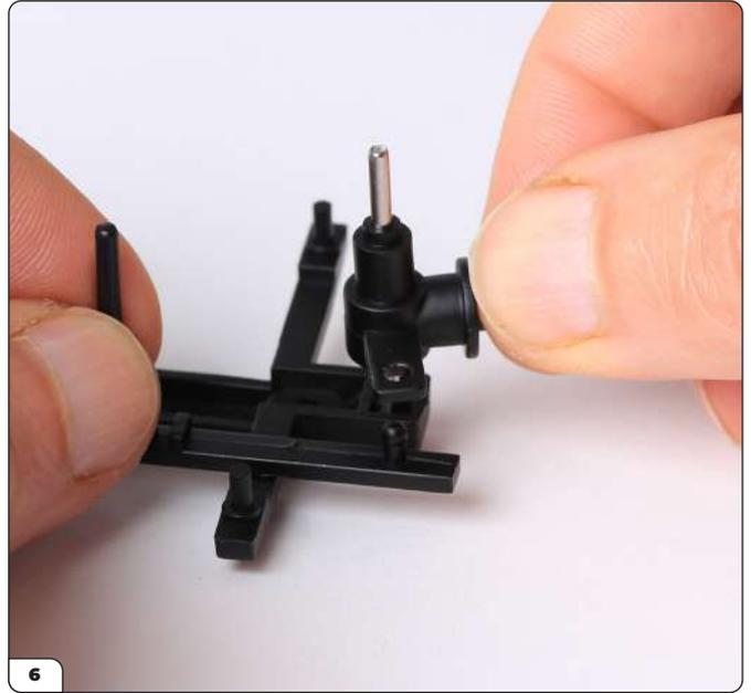
Wiederholen Sie diese Schritte auf der gegenüberliegenden Seite. Heben Sie hierzu die linke Radnabe an und führen Sie das hervorstehende Loch über den Stift an der anderen Seite der Spurstange.
