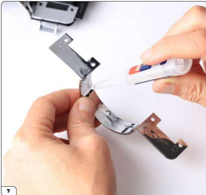
Die Vorgehensweise zum Anbringen der Chrom-Zierleisten im vorderen Bereich des Chassis ist ähnlich. Bringen Sie die Teile auf jeder Seite zunächst probeweise an. Geben Sie ein bisschen Sekundenkleber auf den Flansch an der rechten Zierleiste, und zwar dort, wo der Flansch das Chassis berührt.
