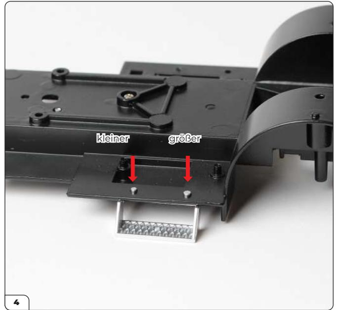
Stecken Sie die Stifte an der Trittstufe in die entsprechenden Löcher an der rechten Seite des Chassis.
