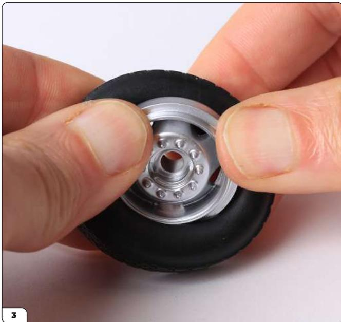
Arbeiten Sie schnell, während der Reifen noch warm ist. Stecken Sie das innere Rad in den Reifen und stülpen Sie dann den Reifen um den äußeren Flansch der Felge.
