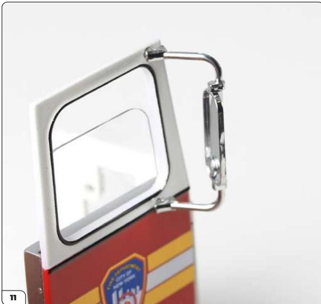
Die Außenspiegel werden wie gezeigt an den Vordertüren der Kabine angebracht. Da sie beim Bauen jedoch leicht beschädigt werden können, ist es besser, sie erst in einer späteren Bauphase anzubringen.
