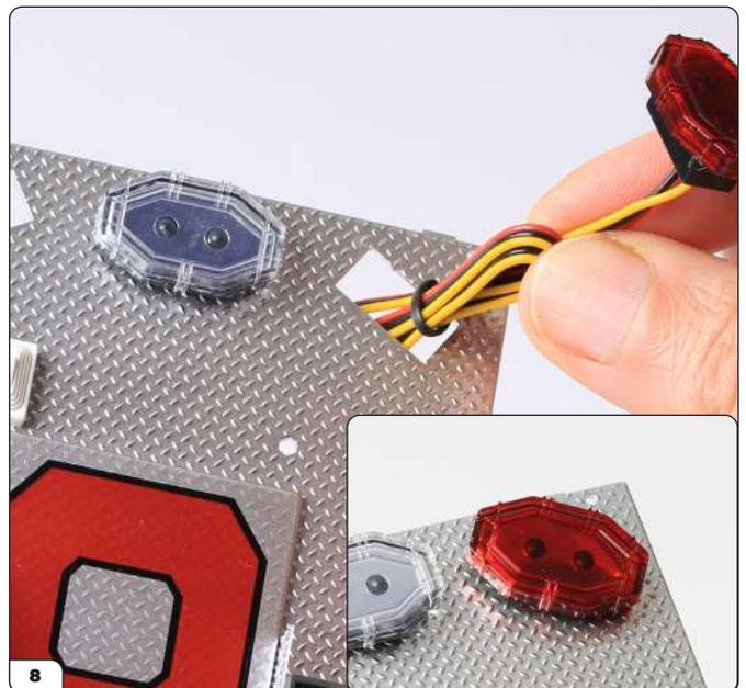
Bringen Sie die LED an. Führen Sie hierzu das Kabel durch die Öffnung im Dach, bevor Sie das Gehäuse fest einstecken.
