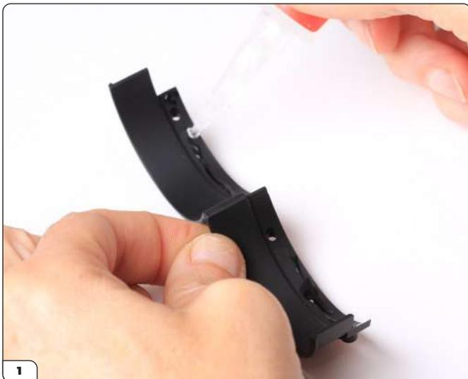
Die Trittstufen sind nun alle angebaut. Im nächsten Schritt werden die Radläufe montiert. Legen Sie die Radläufe zunächst probeweise auf die linke Seite des Hauptchassis auf, bevor Sie den Flansch, der auf dem Chassis liegt, ankleben.
