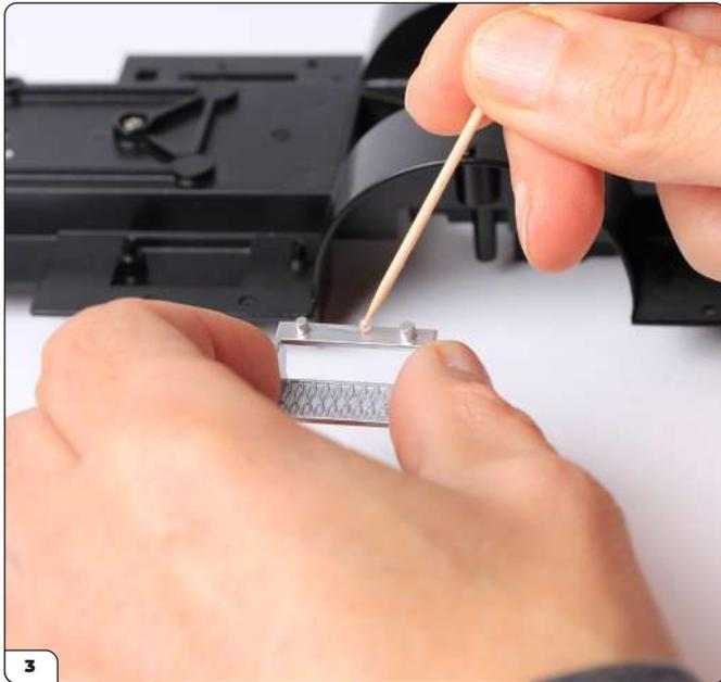
Nehmen Sie jetzt die rechte Kabinen-Trittstufe (die Stifte sind unterschiedlich groß und können somit nur in die entsprechenden Löcher gesteckt werden) und geben Sie etwas Sekundenkleber auf die flache Oberfläche.
