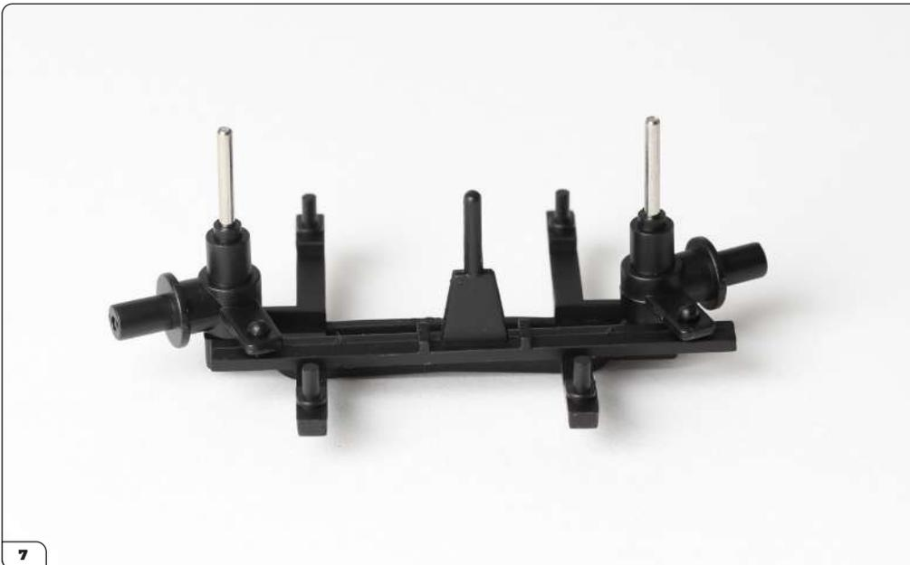
Die Spurstange ist nun eingebaut und verbindet die beiden Radnaben.
