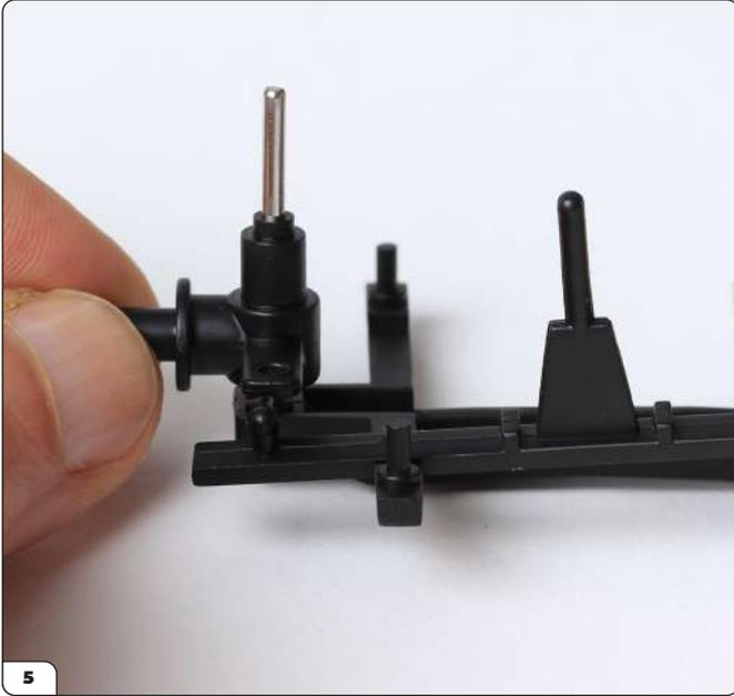
Nehmen Sie jetzt die Spurstange und legen Sie sie auf die Hauptachse, knapp vor den Radnaben. Heben Sie die rechte Radnabe an und führen Sie das Loch im hervorstehenden Zapfen über den Stift an der Spurstange.
