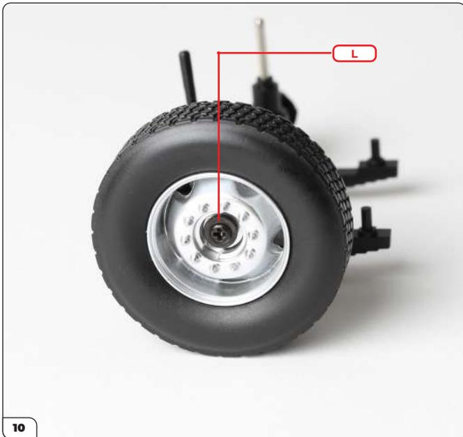
Befestigen Sie das Rad mit 1 L-Schraube aus Bauphase 6. Heben Sie die 2 L-Schrauben, die Sie mit dieser Bauphase erhalten haben, auf. Sie werden in Bauphase 12B benötigt.
