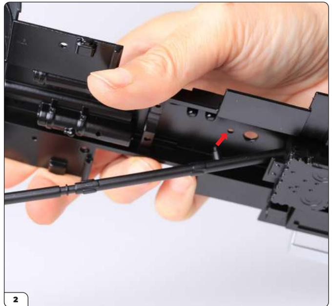
Richten Sie gleichzeitig den Stift am vorderen Ende der Kardanwelle auf das Loch zum vorderen Ende des Hauptchassis aus.
