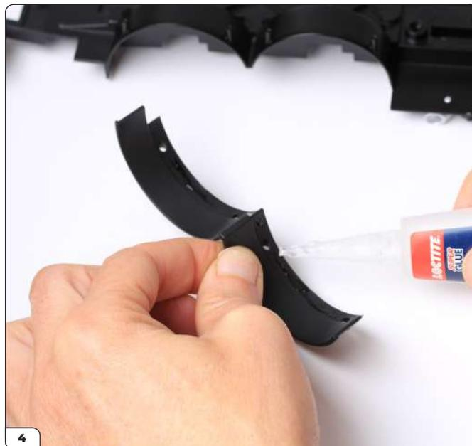
Wiederholen Sie die obigen Schritte, um den zweiten Radlauf an der rechten Seite des Chassis anzubringen. Bringen Sie die Teile probeweise an, bevor Sie ein bisschen Sekundenkleber auf den Flansch geben.
