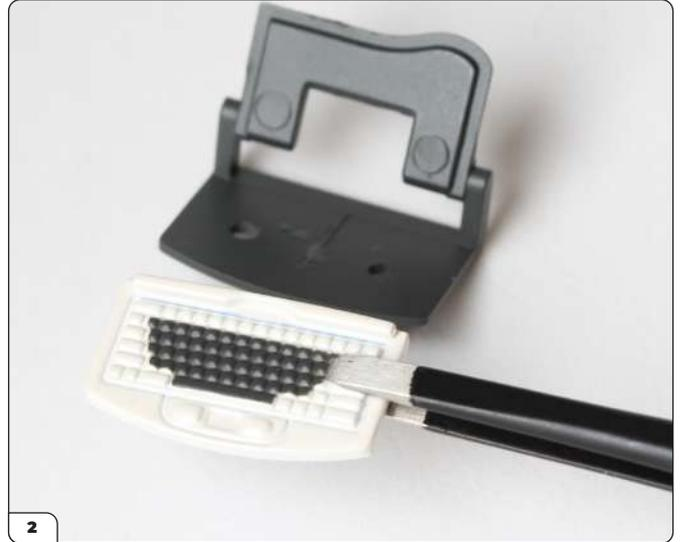
Richten Sie die Stifte an der Unterseite der Tastatur auf die beiden Löcher im Rahmen aus. Vergewissern Sie sich, dass Sie die Tastatur richtig herum ausgerichtet haben (die flache Kante muss nach hinten zeigen). Stecken Sie dann die Stifte fest in die Löcher.
