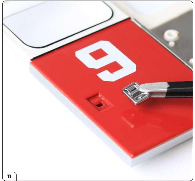
11 Drücken Sie den Griff hinein. Das Loch und der Stift sind halbrund, so dass der Einbau nur in einer Richtung möglich ist.
