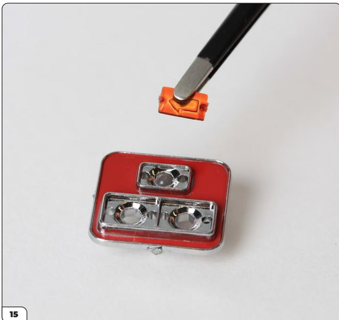
Legen Sie das Glas für den Fahrtrichtungsanzeiger auf den Diffusor, den Sie in Abb. 13 angebracht haben. Vergewissern Sie sich dabei, dass der Pfeil in die in der Abbildung gezeigte Richtung weist.
