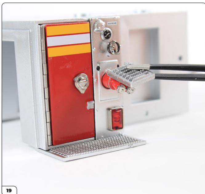
Richten Sie die beiden Zapfen am Trittbrett für die Wasserbehälterplatte auf die beiden noch freien Löcher in der Wasserbehälterplatte aus.
