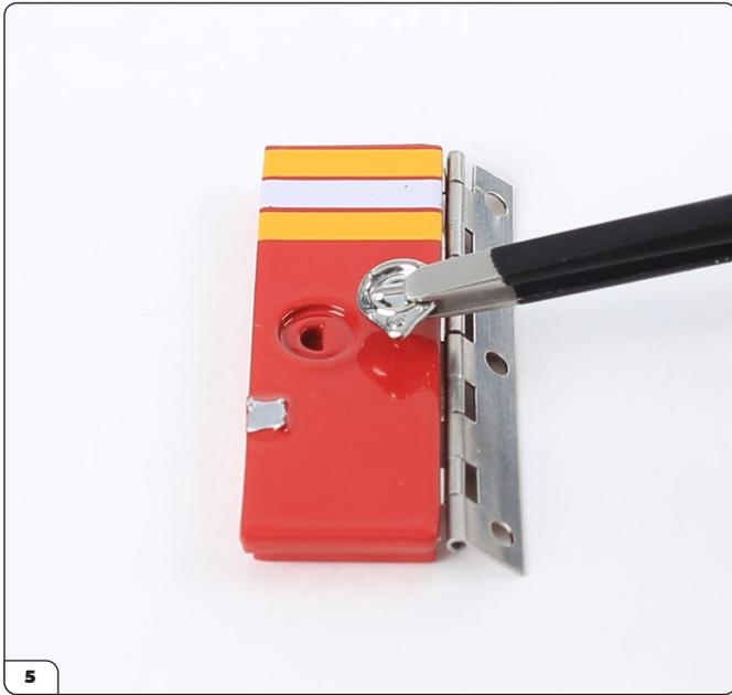
5 Geben Sie ein wenig Sekundenkleber in die Vertiefung für den Griff an der Tür. Richten Sie den Griff wie gezeigt auf die Tür aus. Hinweis: Das Loch und der Stift sind halbrund, so dass der Einbau nur in einer Richtung möglich ist.
