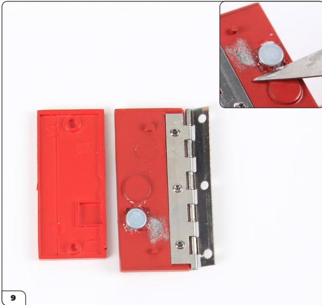
Drehen Sie die Schranktür so um, dass die Rückseite nach oben zeigt. Richten Sie die Schranktür jetzt auf die Schrankinnentür aus. Die beiden Stifte auf der Rückseite der Tür sind für die beiden Löcher an der Innentürverkleidung vorgesehen. Stecken Sie die Teile probeweise zusammen. Hinweis: Gegebenenfalls müssen Sie Grate rund um den Magneten etwas abfeilen (siehe kleines Bild), damit der Magnet in die rechteckige Aussparung in der Türverkleidung passt.
