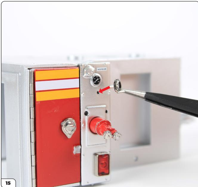
Nehmen Sie eines der Wasserventile und stecken Sie es wie gezeigt in das halbrunde Loch auf der Wasserbehälterplatte. Der Befestigungsstift befindet sich mittig am Ventil. Vergewissern Sie sich, dass Sie das Teil richtig herum anbauen.
