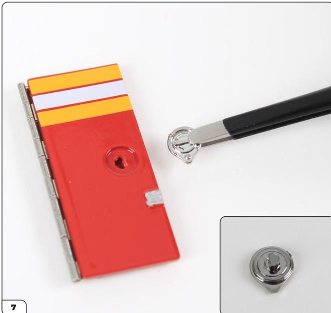
Stecken Sie den Griff in die Vertiefung. Hinweis: Das Loch und der Stift sind halbrund, so dass der Einbau nur in einer Richtung möglich ist.
