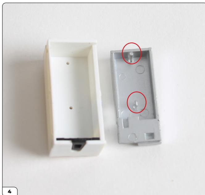
Nehmen Sie die Schalttafel. Beachten Sie, dass sich auf der Rückseite zwei Stifte befinden (eingekreist), die für die zwei Löcher im Schaltschrank vorgesehen sind.
