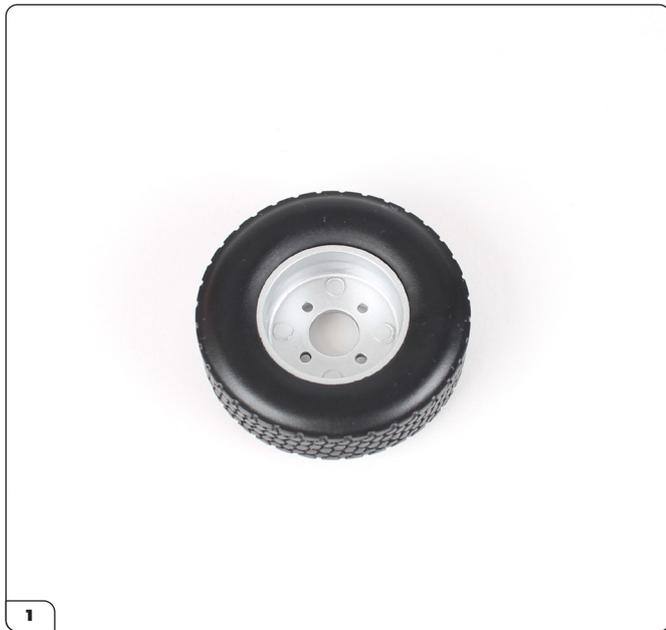
Erwärmen Sie den Reifen eine Minute lang in heißem Wasser. Stecken Sie dann das innere Rad in den Reifen. Der Rand des Reifens muss in der Nut am Rad liegen und bündig mit dem Reifen abschließen.
