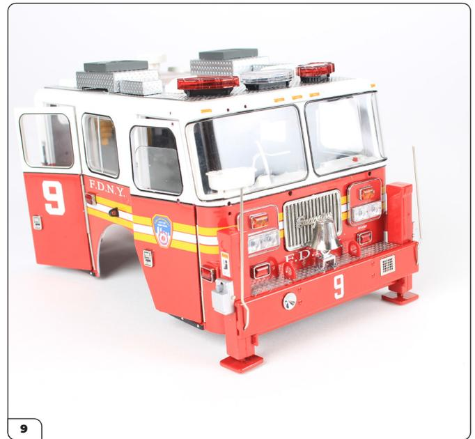
Die vordere Stoßstange ist nun fest an der Kabine angebracht. Die untere Abbildung zeigt, wie die Kabine jetzt auf dem Chassis ruhen kann.
