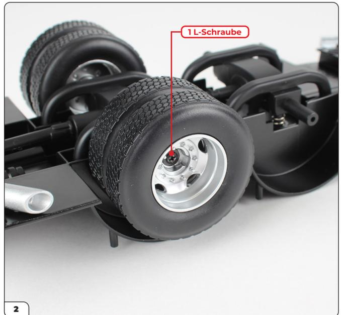
Stecken Sie das Rad auf die Achse und befestigen Sie es mit einer L-Schraube.
