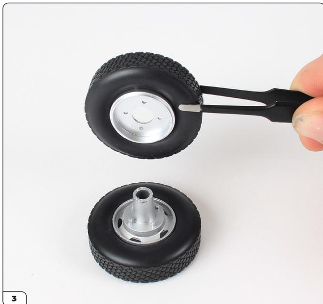
Geben Sie einen Tropfen Sekundenkleber auf die flache Oberfläche des inneren Rads. Richten Sie dann das innere Rad auf das äußere Rad aus und stecken Sie die beiden Reifen zusammen. Drücken Sie die beiden Reifen fest zusammen.
