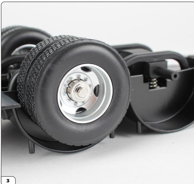
Stecken Sie die Radkappe über die Schraube, die in Abb. 2 angebracht wurde.
