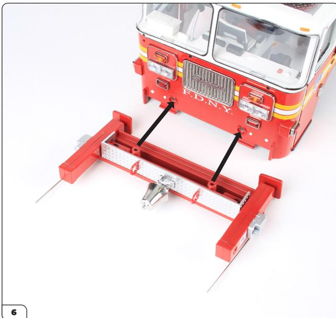
Nehmen Sie die Kabinen-Baugruppe und richten Sie sie wie gezeigt auf die vordere Stoßstangen-Baugruppe aus. Die zwei erhöhten Schraublöcher an der Stoßstange passen in die entsprechenden Löcher in der Kabine (siehe Pfeile).
