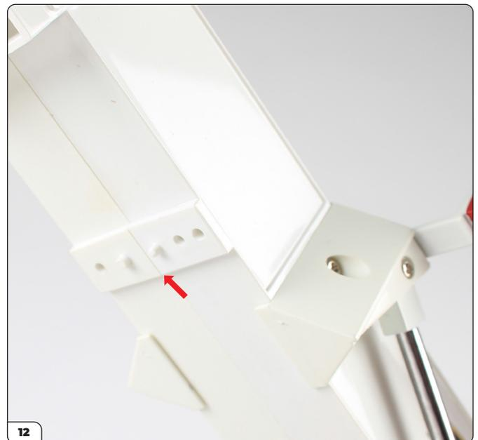
Die Baugruppe aus Schritt 11 passt an den gezeigten Befestigungspunkten an die Unterseite des Auslegers.
