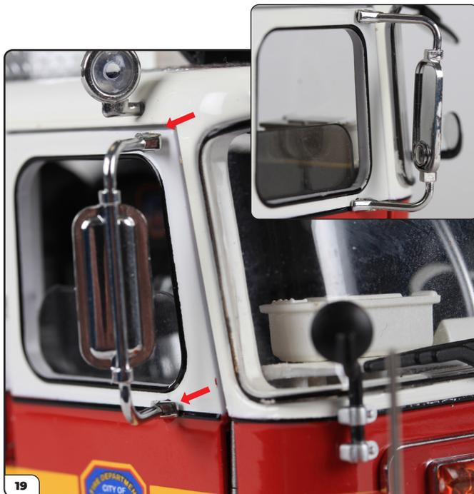
Fissa lo specchietto per l'ala destra, premendolo saldamente nei due punti di fissaggio indicati sopra.
