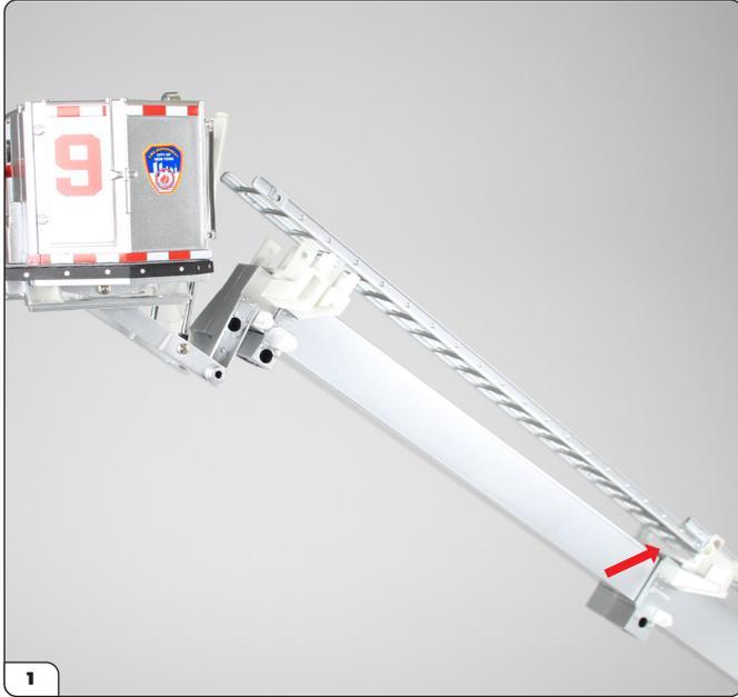
Controlla di avere la scala nella giusta posizione, con i fori per le viti in alto, e inserisci l'estremità inferiore nel supporto della scala sotto la sezione precedente della scala.
