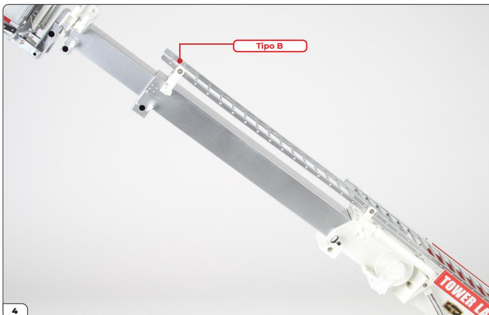
Estendi la seconda scala fino a quando i fori per le viti all'estremità superiore non si allineano con il supporto della scala sulla sezione media inferiore. Fissa la scala al supporto utilizzando 2 viti di tipo B.
