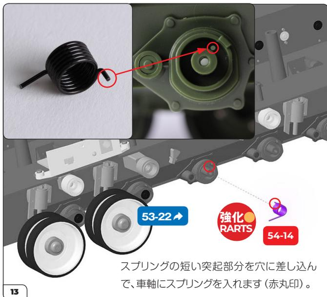
スプリングの短い突起部分を穴に差し込んで、車軸にスプリングを入れます (赤丸印)。
