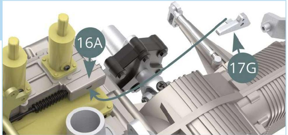
17A Rückholfeder zwischen 17G Halterung und 17D Kipphebelachse montieren.
