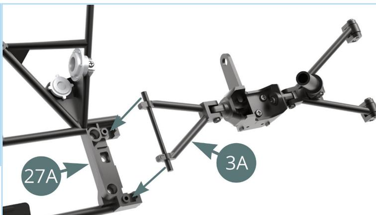
Fija el conjunto de la suspensión delantera izquierda al marco introduciendo las dos **placas (27B)** en el **brazo de control superior (3A)** y fijándolas con un tornillo **BM**.
