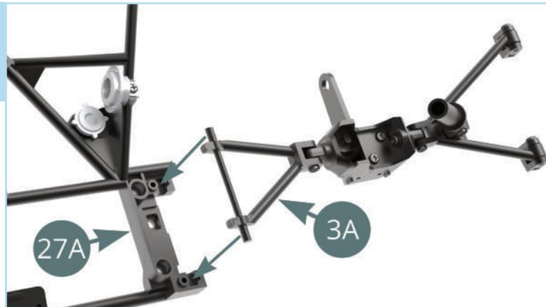
Befestigen Sie die obere Schwinge 3A mit den Halterungen 27B und zwei BM-Schrauben am Armaturenbrettrahmen 27A.
