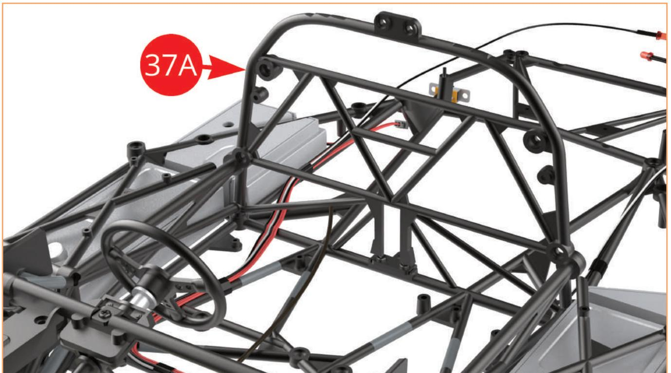
Cockpittrennwandrahmen (37A) auf dem Fahrgestell montiert.
