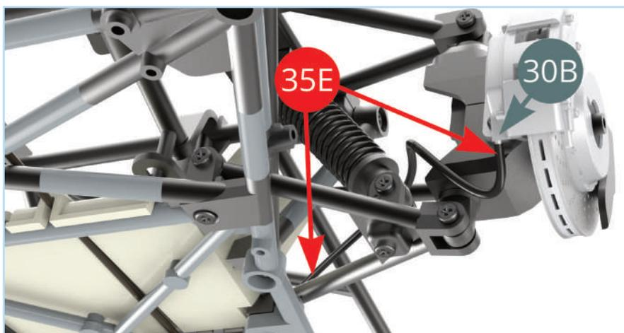
Toma la **manguera de freno derecha** más corta (**35E**) y encaja uno de sus extremos en el pequeño pasador situado debajo de la **tapa del pistón de freno** derecho (**30B**). Pasa el otro extremo alrededor del amortiguador.
