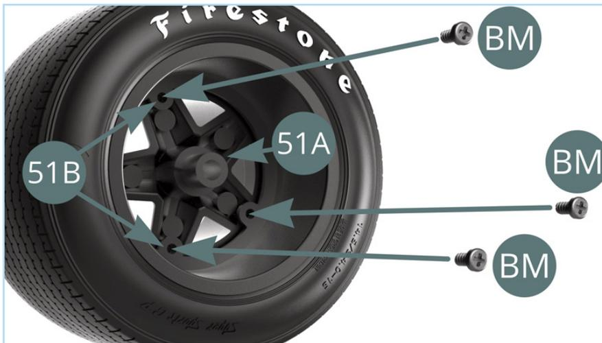
Utiliza tres tornillos **BM** para unir la llanta interior a la exterior.
