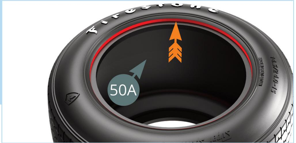
El talón más grande (2 mm) se indica con la flecha verde. Localiza el lado con el talón más grande para introducir la llanta exterior en el neumático.
