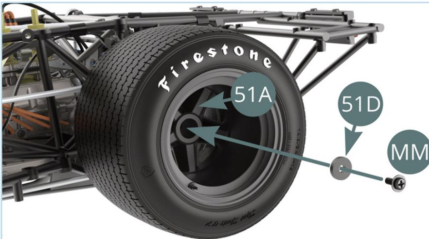
Toma un tornillo **MM** e introdúcelo en la **arandela (51D)**, luego utilízalos juntos para fijar el neumático trasero izquierdo.
