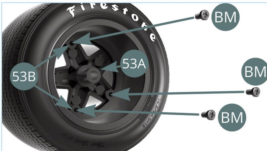
Utiliza tres tornillos **BM** para fijar la llanta interior y la exterior.
