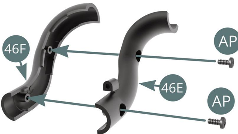
Verbinden Sie die beiden Kühlleitungshälften (46F und 46E) und mit zwei AP-Schrauben sichern.
