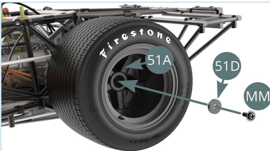
Befestigen Sie die äußere Felge des linken Hinterrads (51A) mit einer MM-Schraube, indem Sie sie zunächst durch die Unterlegscheibe (51D) führen.
