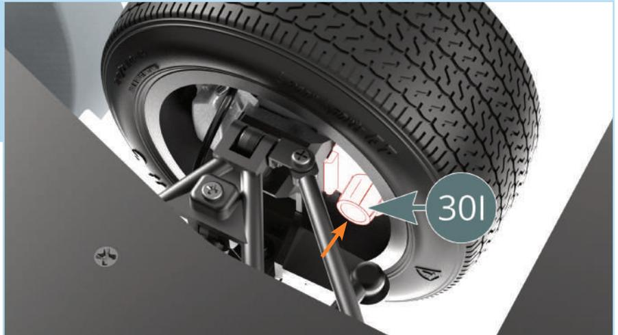
Positionieren Sie den rechten Kühlmantel der Bremse (78B) über dem Lufteinlass am rechten Bremskraftregler (30I) - hier von oben gesehen.
