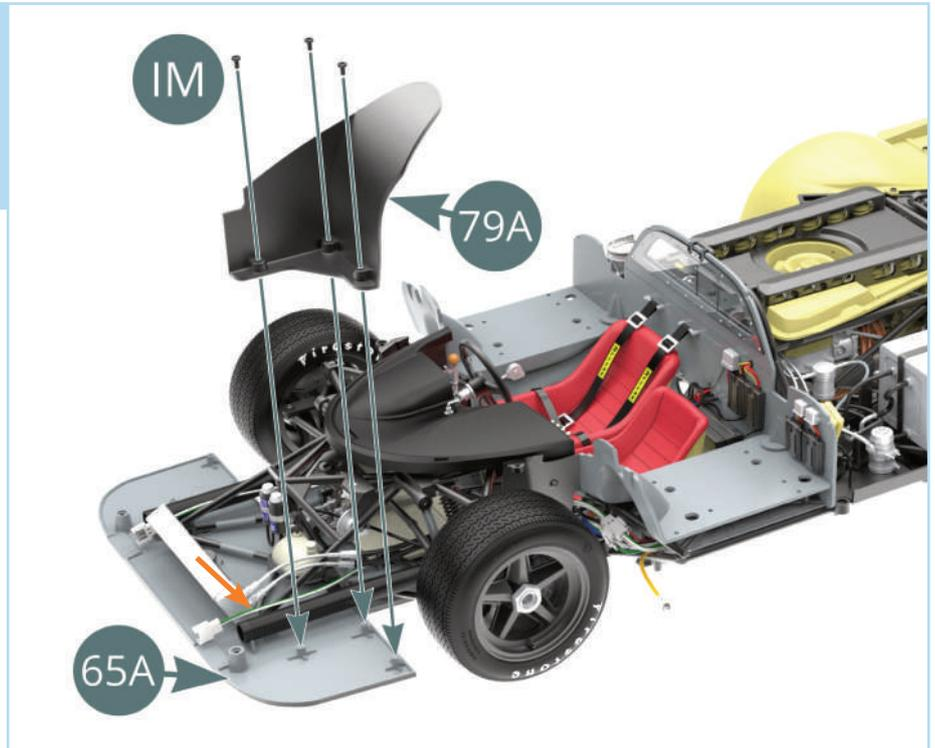
Positionieren Sie den rechten Radkasten (79B) auf dem vorderen Flachboden (65A) und befestigen Sie ihn mit drei IM-Schrauben.
