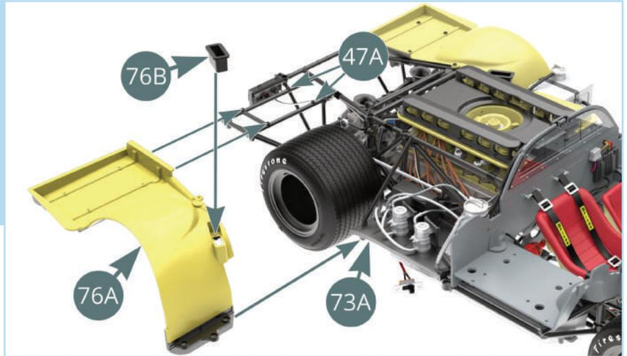
Sichern Sie den rechten hinteren Radkasten (76A) mit fünf IM-Schrauben am oberen Rahmen (47A).
