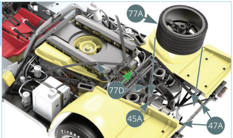
Den Ersatzradgurt (77D) über das Ersatzrad (77A) kippen, wobei der Schnellspannhebel jetzt nach oben zeigt - roter Pfeil. Korrigieren Sie die Straffheit des Knotens an der oberen Rahmenstange (47A) - grüner Pfeil. Zum Abschluss das Ersatzrad mit den beiden freien Enden - in Blau gezeigt - des Ersatzradgurtes (77D) an den oberen Rahmenstangen festbinden.
