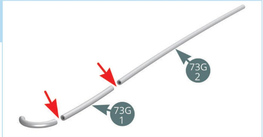
Schließen Sie die Kraftstoffleitung (73G-2) an den Nippel der rechten Seitenplattform (73A) an.
