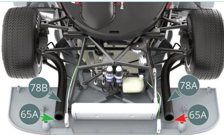
Stellen Sie den rechten (78B) und den linken (78A) Kühlmantel der Bremse so ein, dass sie im rechten (grüner Pfeil) bzw. linken (roter Pfeil) Schlitz an der Vorderseite des Flachbodens vorne (65A) sitzen.
