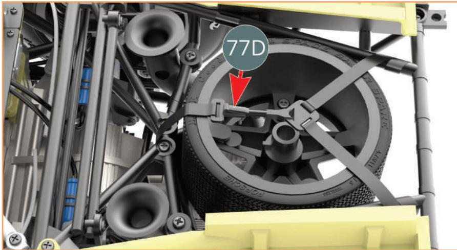
Das Ersatzrad wird mit dem Ersatzradgurt (77D) an der Oberseite befestigt
