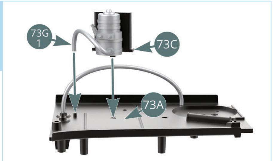
Die Kraftstoffpumpe (73B) wird auf der rechten Seitenplattform (73A) installiert
