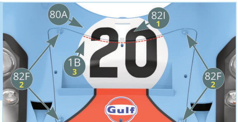
Falten und streichen Sie den unteren Rand des Aufklebers (rote Pfeile) auf die Karosserie (80A) und warten dann 3 Minuten, bis er ausgehärtet ist. Wenn der Aufkleber vollständig getrocknet ist, stechen Sie zwei Nadellöcher in die Oberseite des Aufklebers, wie durch die roten Pfeile angezeigt.
