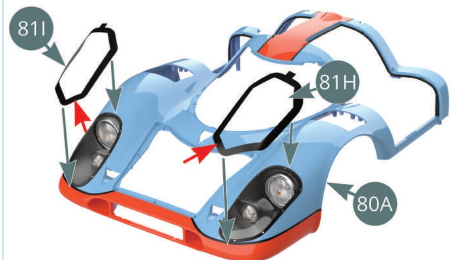
Die transparente Folie der Scheinwerfer-Abdeckungen wird beim Anbringen leicht faltig - das ist normal und entspricht dem Schutz für die echten Autos.
