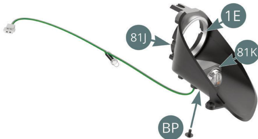
Setzen Sie das kleine Scheinwerfer-Gehäuse (L) (81K) auf das neue linke Scheinwerfer-Gehäuse (81J) und befestigen Sie es mit einer BP-Schraube.
