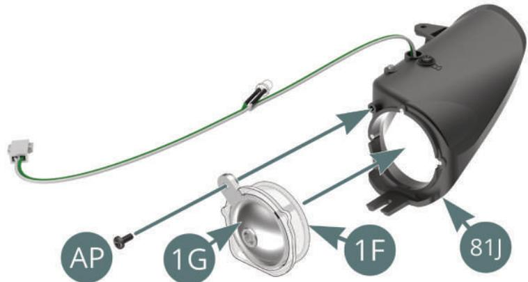
Schließen Sie die zweite LED des Scheinwerfer-LED-Kabels (35F) an den großen Scheinwerfer-Reflektor (1G) an.
