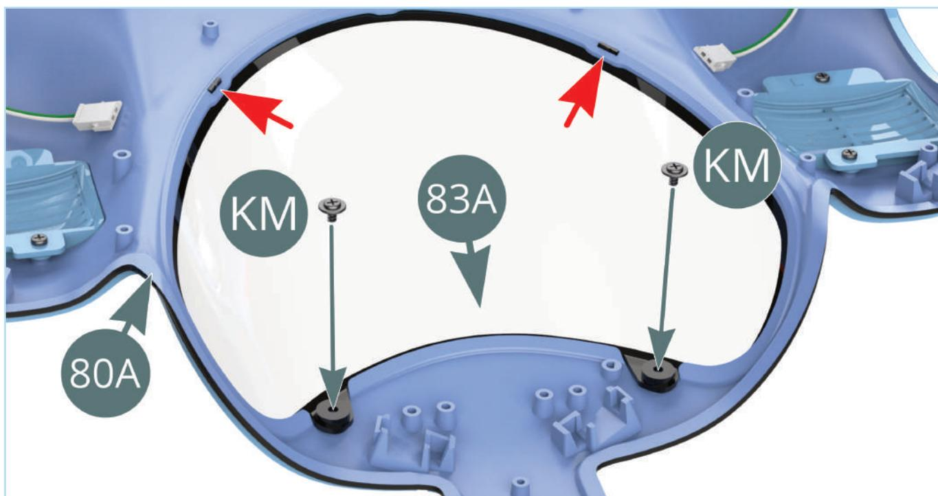
Überprüfen Sie, ob die beiden Laschen der Windschutzscheibe (83A) richtig in den Schlitz der Karosserie (80A) angeordnet sind - rote Pfeile - und sichern Sie die Windschutzscheibe mit zwei KM-Schrauben.
