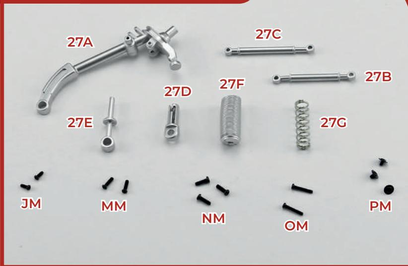
27A Hinterradaufhängung, linker Querlenker
