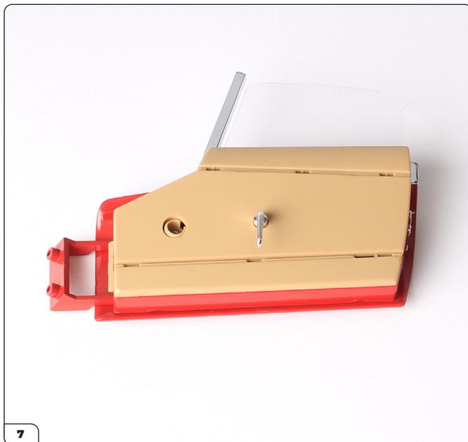
Spingi il pannello di rivestimento saldamente in posizione per fissarlo.
