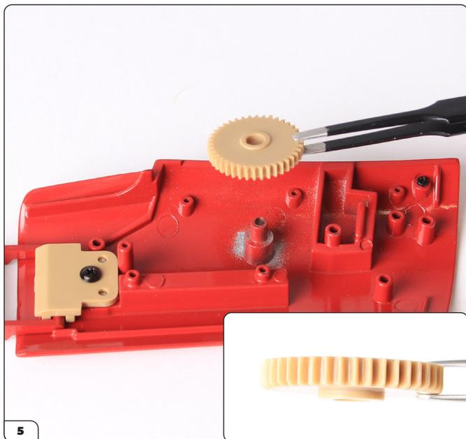
Prendi il grande ingranaggio e allinealo con la porta, assicurandoti che la scanalatura più profonda al centro dell'ingranaggio sia rivolta verso il basso.
