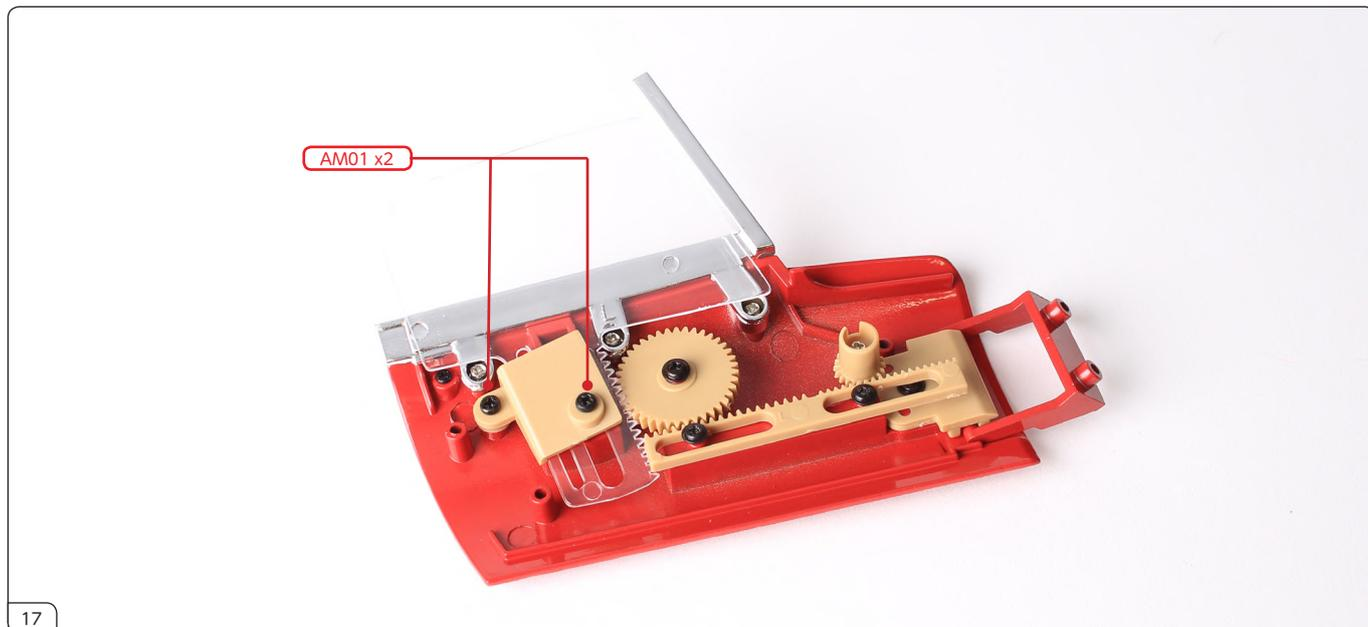
AM01のネジ2本でウィンドウリテーナを固定します。窓が上下にスライドするように、ネジは締めすぎないようにしてください。小ギアを回転させると、ウィンドウが上下に動くことを確認してください。
