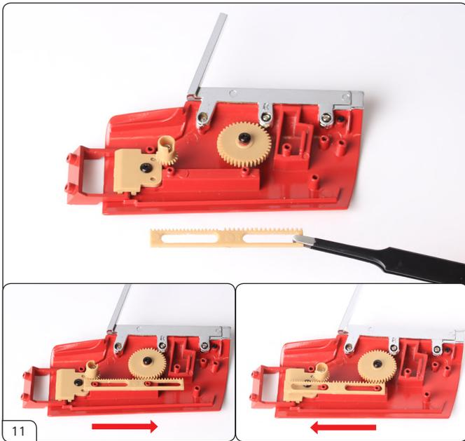
ラックギアを写真のように配置します。ラックギアを左右に軽くスライドさせると、大小のギヤが回転することを確認します。
