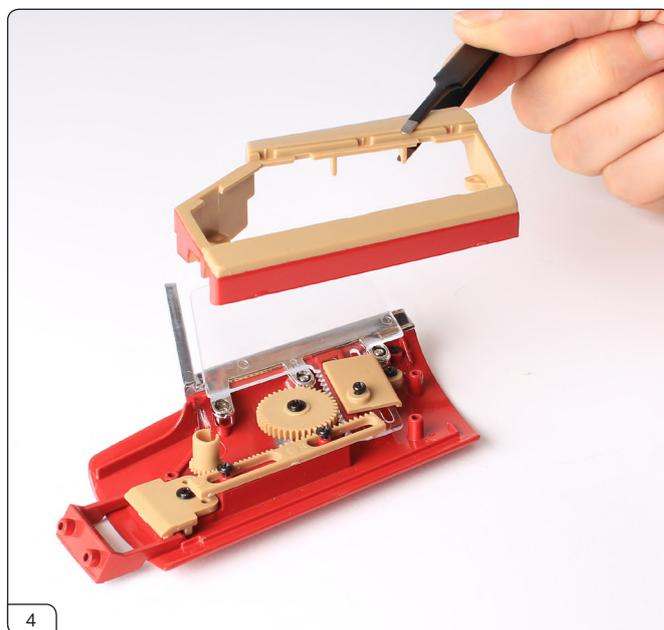
ステップ⑨で組み立てた運転席ドアパーツの内側に、運転席ドアトリムをはめ込みます。
