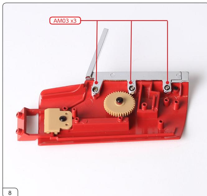
AM03のネジ3本で、ウィンドウ枠を固定します。
