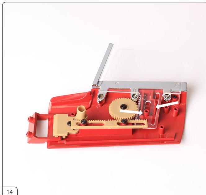
ネジ穴の開いた突起(白矢印)とバー状の突起(白矢印)が、ウィンドウに開いた穴に収まるように配置します。
