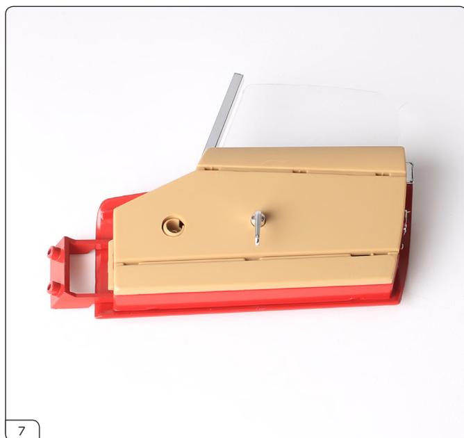
運転席ドアトリムパネルをしっかりと押し込んで、2つのパーツを固定します。
