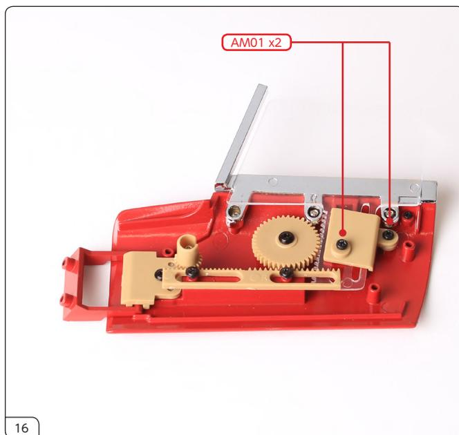
AM01のネジ2本でウィンドウリテーナを固定します。窓が上下にスライドするように、ネジは締めすぎないようにしてください。小ギアを回転させると、ウィンドウが上下に動くことを確認してください。
