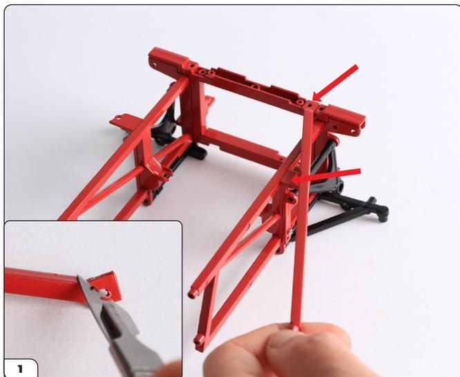
Allinea la staffa superiore con l'assemblaggio della fase 20 come mostrato. Si adatta ad un angolo, appoggiandosi sul traverso anteriore e sul longherone dove mostrato (freccie). Se il quadrato curvo non si adatta perfettamente alla cavità, prova a raschiare via l'eccesso di vernice come mostrato (riquadro).
