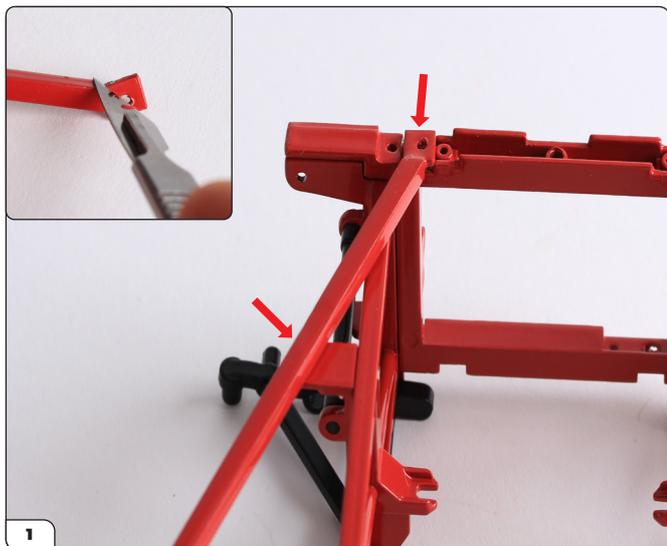
Allinea la staffa superiore con l'assemblaggio nei due punti indicati dalle frecce, rimuovendo l'eccesso di vernice se necessario per garantire una buona vestibilità.
