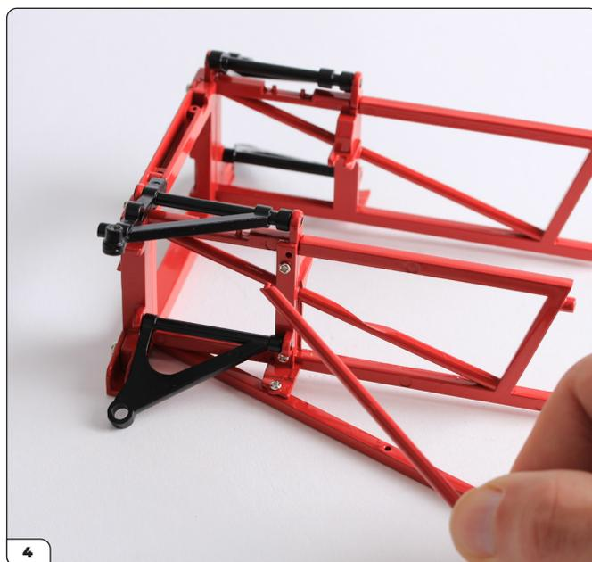
Allinea il perno all'estremità della staffa diagonale con il foro nell'assemblaggio come mostrato.
