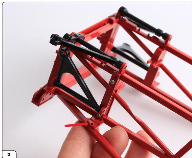
Tenendo la staffa in posizione, gira l'assemblaggio in modo da poter accedere al punto di fissaggio sul longherone (freccia).
