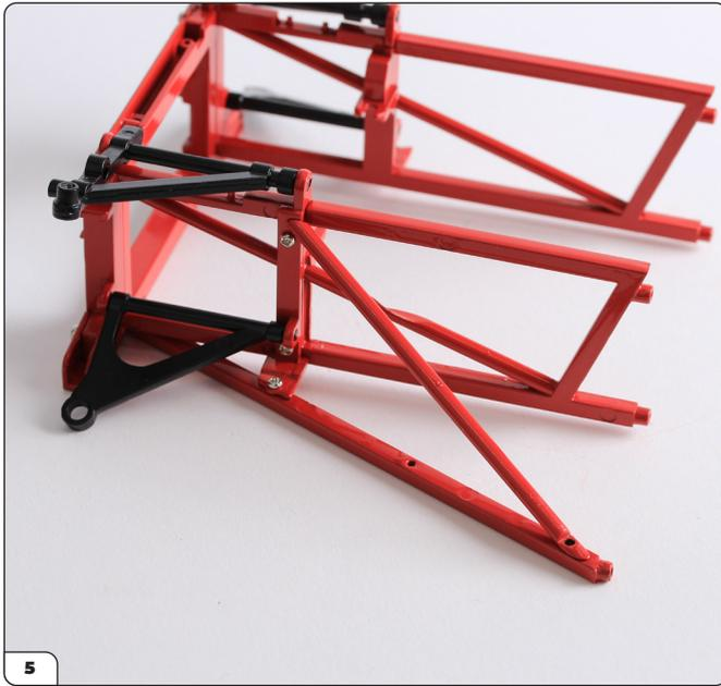
Fit il perno nel foro, allineando il foro nell'altra estremità della staffa diagonale con il corrispondente foro nel longherone come mostrato.
