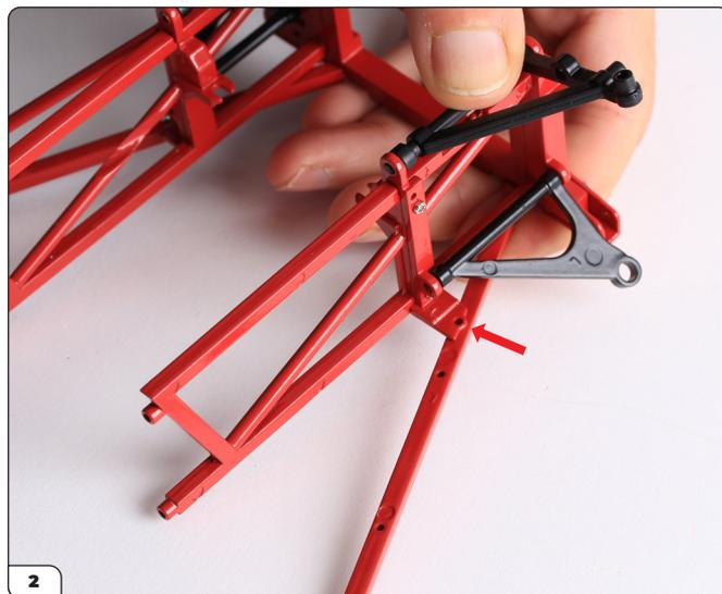
Tenendo tutto in posizione, gira l'assemblaggio in modo da poter accedere al foro nel longherone.
