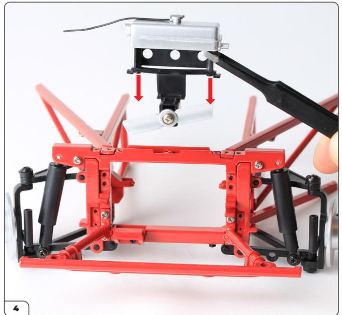
Abbassare l'assemblaggio del ventilatore di raffreddamento dalla fase 30 sul telaio ausiliario (vedere il passo 5).
