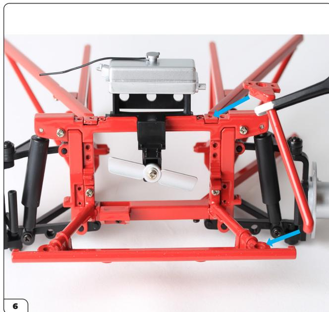
Prendere il supporto sinistro del telaio ausiliario frontale e allinearlo con il telaio come mostrato. I tre fori all'estremità più larga si adattano accanto al supporto del serbatoio di espansione; l'estremità opposta si inclina verso il basso e si adatta nel foro sulla base del telaio ausiliario frontale.
