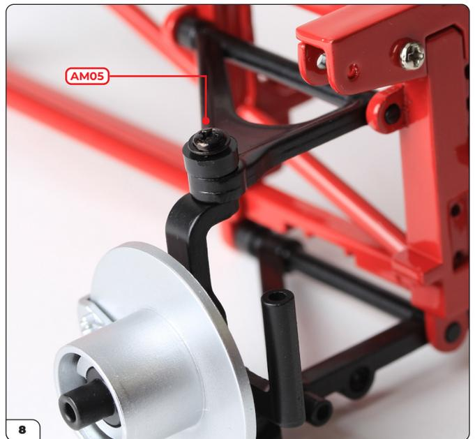
Fissa la boccia di sospensione al montante della sospensione con una vite AM05. Non stringere troppo la vite in quanto il montante deve essere libero di girare.
