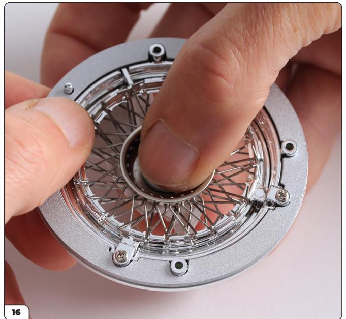
Continua a tenere saldamente il centro della ruota, mentre agganci delicatamente le estremità dei raggi A e B attorno ai denti. Usa il tuo pollice in un movimento di carezza, o le pinzette qui. La vestibilità dei raggi può essere leggermente regolata premendo e/o ruotando dolcemente il centro della ruota con il tuo pollice.
