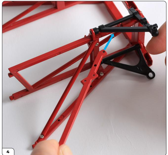
Con l'assemblaggio del telaio capovolto sulla tua superficie di lavoro, prendi la staffa inferiore sinistra e infilala tra il triangolo inferiore e il fondo del telaio (vedi anche il passaggio 5).
