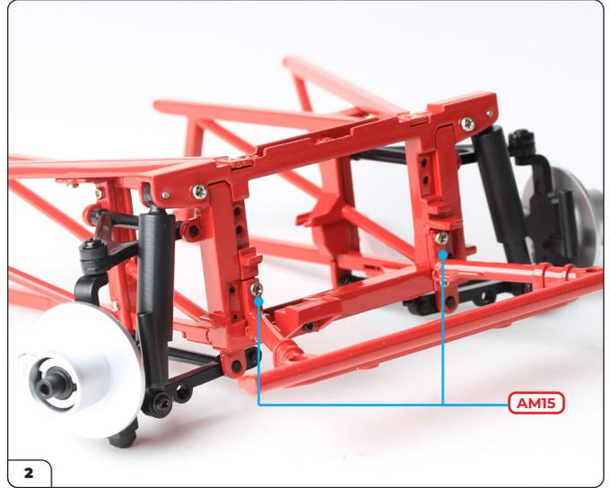
Inserire i montanti delle viti sulla base del telaio ausiliario nelle relative cavità dell'assemblaggio e fissare in posizione usando 2 viti AM15.
