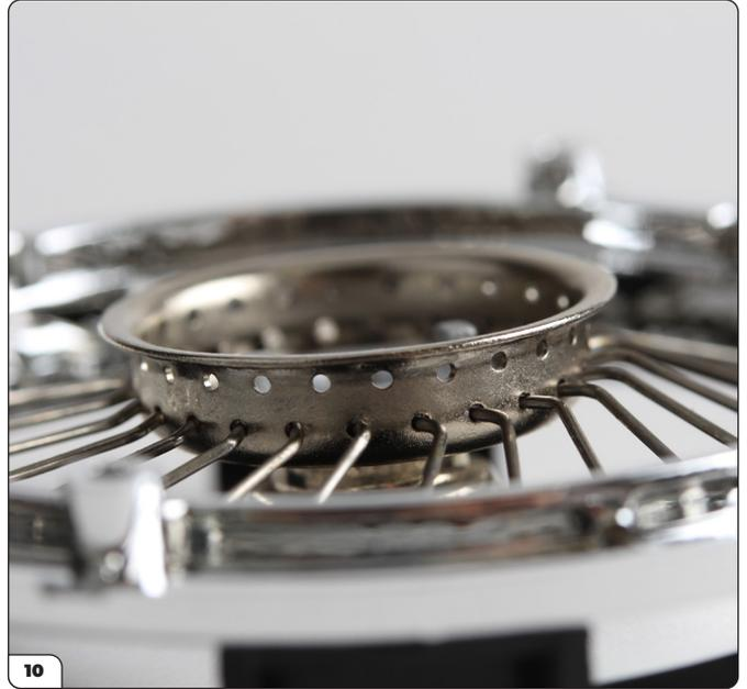
Verifica che tutti i raggi siano stati montati sulla fila più interna del centro della ruota. Successivamente, monterai i raggi sulla fila più alta.
