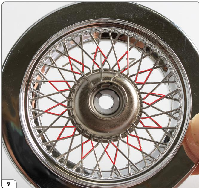
Continua a passare i raggi di tipo A tutto intorno alla fila interna, spingendo la punta attraverso le aperture a forma di diamante alternate come indicato.
