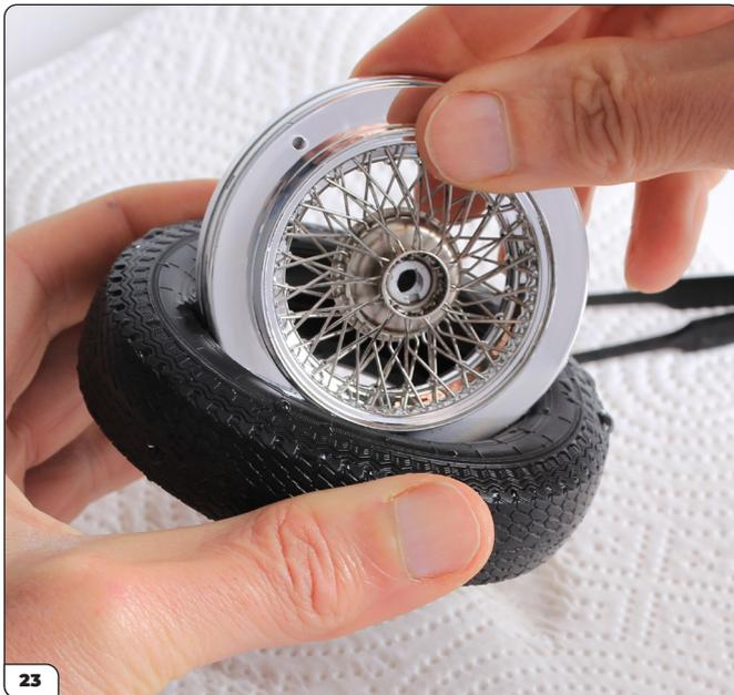
Lavorando rapidamente mentre il pneumatico è malleabile, spingi la ruota nel pneumatico e ruota per adattare il cerchio della ruota esterna sotto il bordo interno del pneumatico.
