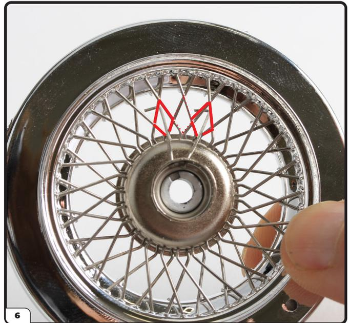
Una volta che sei sicuro che il primo raggio sia montato correttamente, infila il raggio successivo attraverso un foro adiacente nella fila inferiore, ma questa volta, infilalo nel foro a forma di diamante che è al secondo posto.
