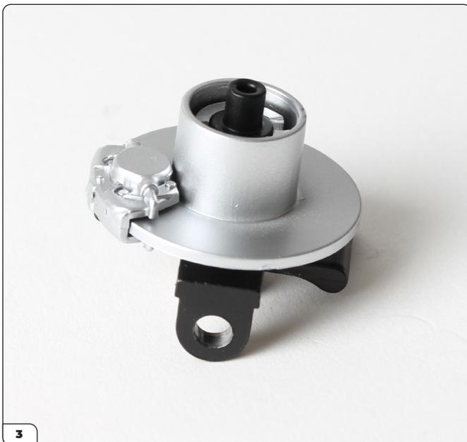
Il disco freno e la pinza sono correttamente posizionati sul montante della sospensione. Controlla che il lato inferiore della pinza si adatti al perno di posizionamento.
