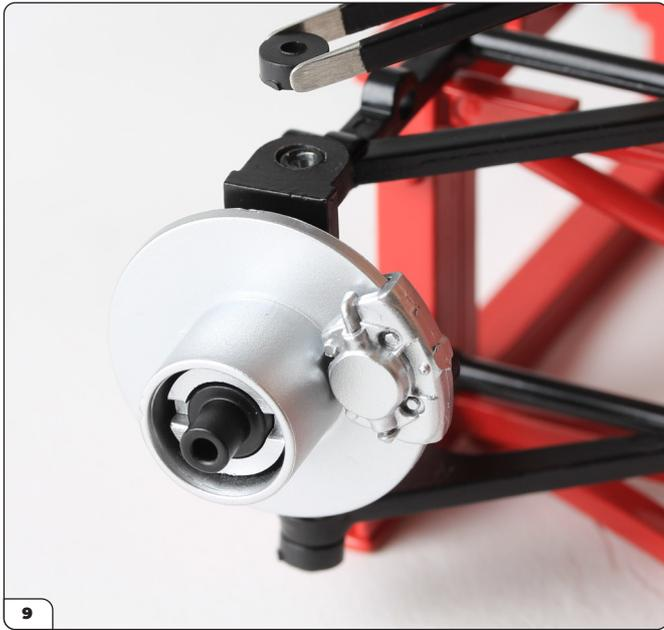
Monta l'altra boccola di sospensione sopra il foro e la punta del braccio oscillante inferiore.
