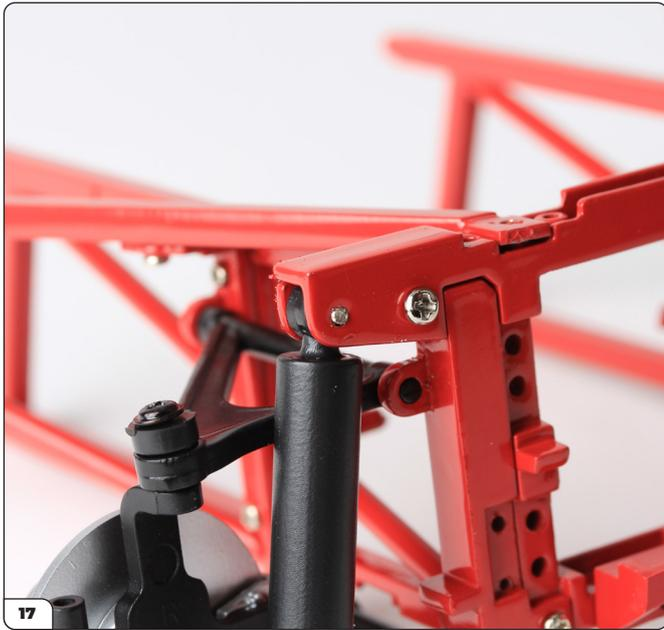
Il perno di pivot ora fissa la protezione dell'ammortizzatore in posizione.
