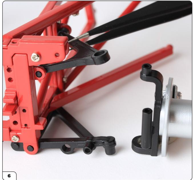
Allinea l'assemblaggio del disco freno con le braccia oscillanti superiori e inferiori sul telaio dalla fase 26.
