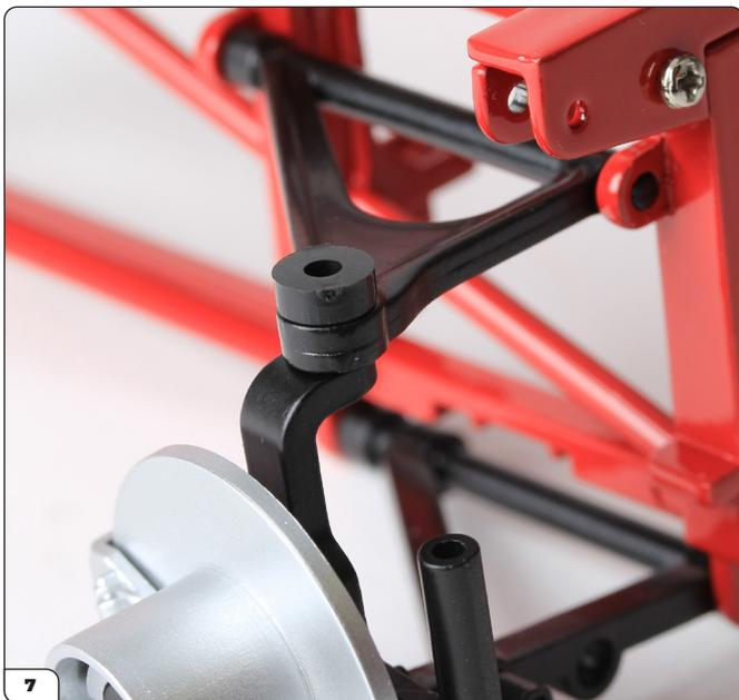
Una boccia di sospensione si posiziona sopra il triangolo superiore.
