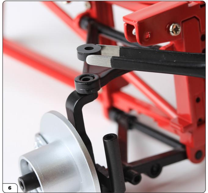
Monta le estremità delle braccia oscillanti superiore e inferiore sul montante della sospensione. Monta una boccia di sospensione sul foro sul braccio oscillante superiore.
