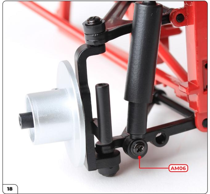
Spingendo la molla e il corpo dell'ammortizzatore nella protezione dell'ammortizzatore, adattare l'occhio del corpo dell'ammortizzatore sull'oscillante inferiore e fissarlo in posizione con una vite AM06.
