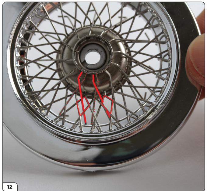
Quando passi il raggio di tipo B attraverso il lato opposto, dovrebbe incrociare un raggio di tipo A e inserirsi in una apertura a forma di diamante vuota. Dovrebbe essere leggermente in senso antiorario. Controlla che aggancerà un dente largo, ma non agganciarlo ancora, lascia i raggi allentati.
