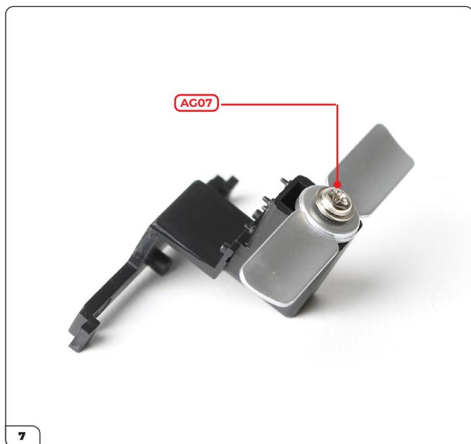
Fissare il ventilatore in posizione con una vite AG07.
