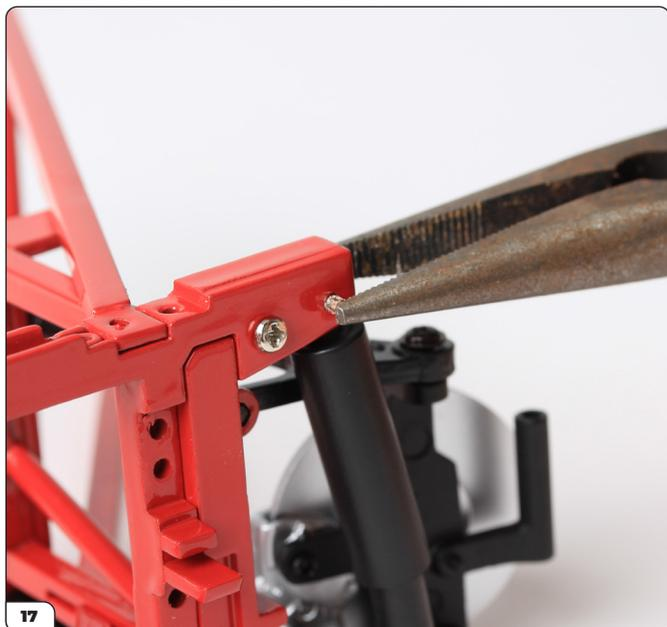
Stringi il perno con la pinza per premere completamente nel foro.
