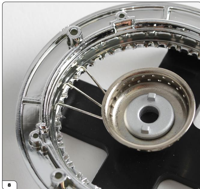
Monta il terzo raggio nello stesso modo, e continua in tutto il cerchio della ruota fino a quando non avrai riempito tutti i fori sulla fila interna del centro della ruota. Verifica che siano agganciati attorno ai denti larghi. Se non sono agganciati attorno ai denti larghi, i raggi non si adatteranno e le parti della ruota non si adatteranno insieme alla fine della costruzione.
