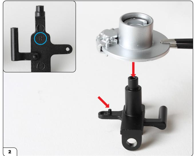
Monta il disco freno sulla parte centrale del montante della sospensione destra, assicurandoti che la pinza sia allineata con il perno di posizionamento.
