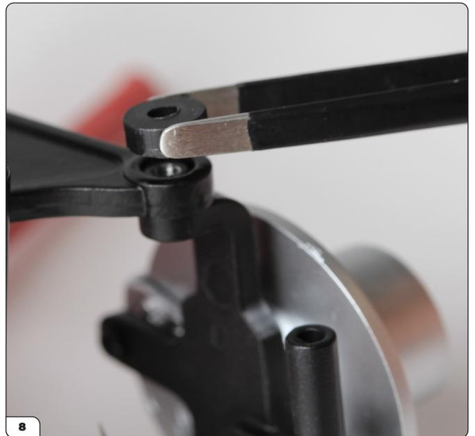
Monta una boccia di sospensione sul foro sulla braccia oscillante superiore.
