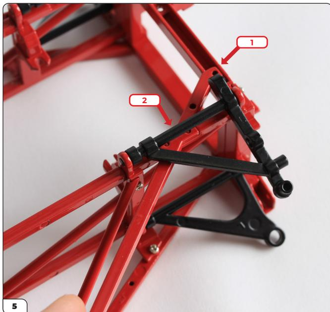
Inserisci l'estremità della staffa inferiore nell'incavo sul traversa anteriore (freccia n. 1). Controlla che la staffa si incastra con il telaio (freccia n. 2).
