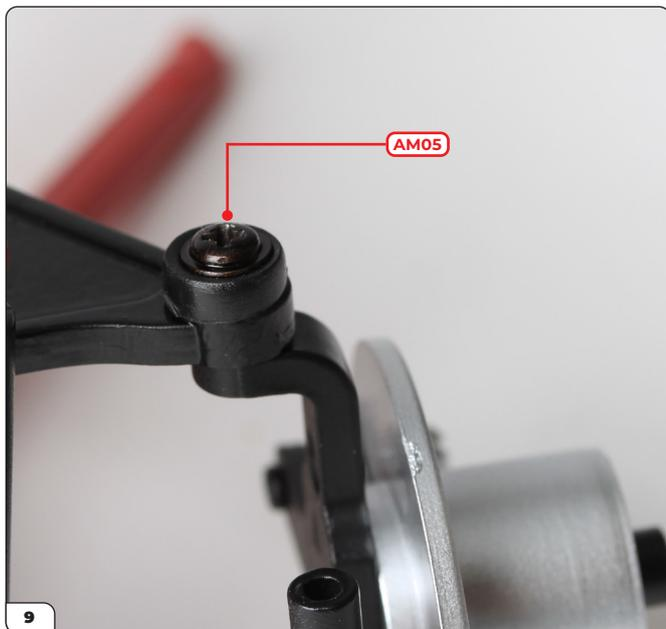
Fissa la boccia di sospensione al montante della sospensione con una vite AM05. Non stringere troppo la vite perché il montante deve essere libero di girare.
