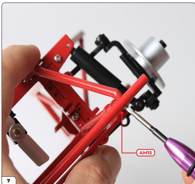
Fissare il supporto sinistro in posizione da sotto il telaio ausiliario con una vite AM15.
