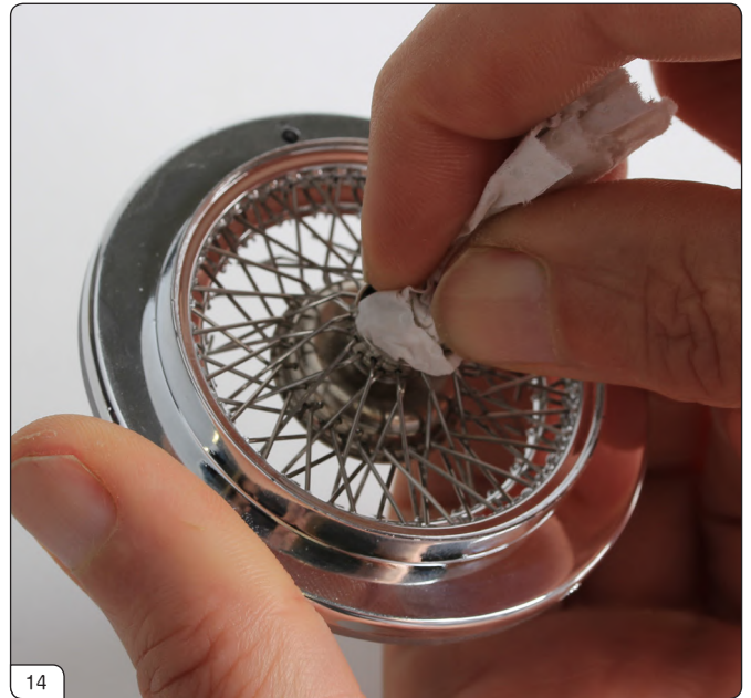
コットンないしキッチンペーパーを用いて、スポークのフラットヘッド部分を押し込むようにして、フラットヘッドを所定の位置に固定します。
