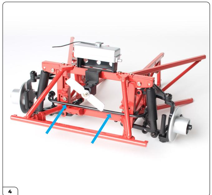
Posiziona la barra antirollio sulla parte anteriore del telaio ausiliario, all'interno dei triangoli formati dai supporti diagonali nella parte anteriore del telaio ausiliario.
