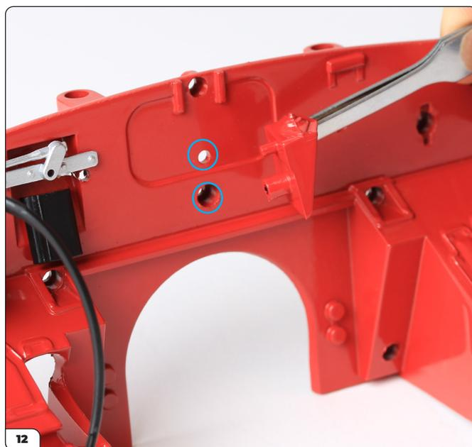
Allinea i due perni sul montaggio stabilizzatore motore con i due fori sulla paratia (cerchiati).
