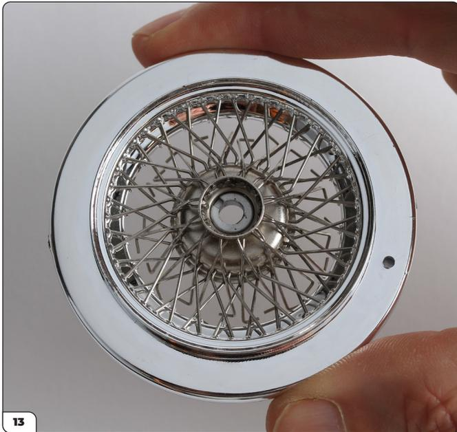
Tutti i 12 raggi di tipo B sono stati montati sulla fila esterna del centro della ruota e sono lasciati allentati sul lato inferiore.
