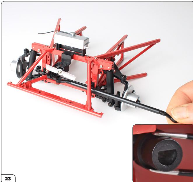
Ora infila l'assemblaggio del piantone di sterzo attraverso le staffe triangolari nella parte anteriore del telaio ausiliario. Verifica che i denti sul piantone siano posizionati in modo tale che si allineino con l'ingranaggio. Nota: quando le ruote sono puntate dritte in avanti, il lato piatto della "D" alla fine dell'assemblaggio della colonna di sterzo (opposto all'ingranaggio) dovrebbe essere livellato e rivolto verso l'alto (inserito).
