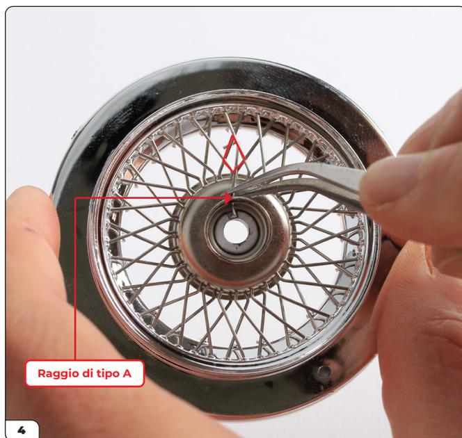
Utilizzando una pinzetta, infilate un raggio di tipo A attraverso un buco sulla fila interna. Indirizzate la punta del raggio attraverso l'apertura a forma di diamante leggermente in senso orario (colorato di rosso sopra) in modo che la punta spunti dal lato opposto.
