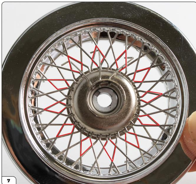
Continua a infilare i raggi di tipo A tutto intorno alla fila interna, spingendo la punta attraverso le aperture a forma di diamante alternate come indicato.
