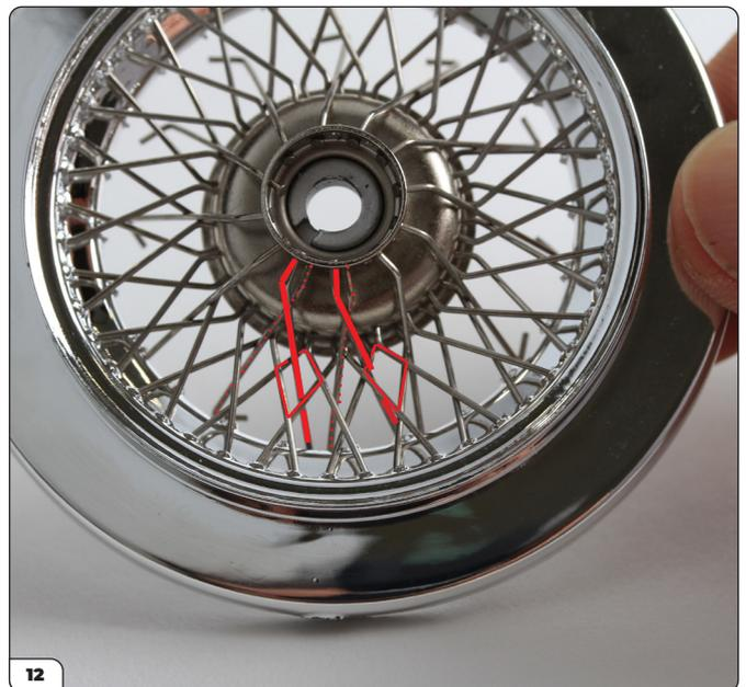
Quando infilati il raggio di tipo B attraverso il lato opposto, dovrebbe incrociare un raggio di tipo A e passare attraverso un'apertura a forma di diamante vuota. Dovrebbe portare leggermente in senso antiorario. Controlla che aggancerà un dente largo, ma non agganciarlo ancora, lascia i raggi allentati.
