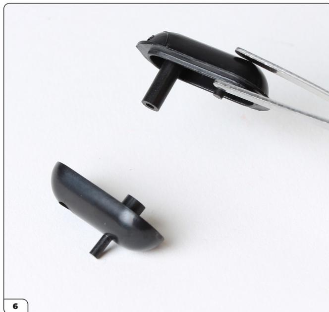
Allinea le due metà del serbatoio di riserva, abbinando i perni di posizionamento e i fori.
