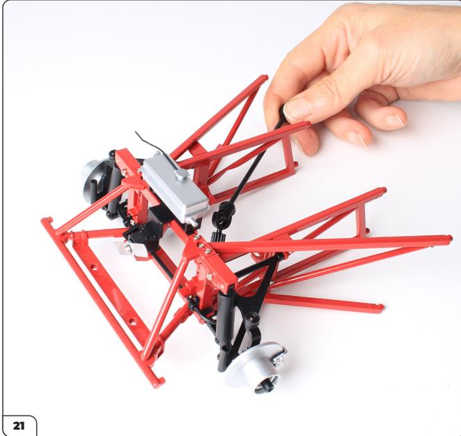
Tornando all'assemblaggio del subframe, infila l'assemblaggio della colonna di sterzo attraverso il subframe fino a quando l'ingranaggio alla fine della colonna di sterzo si posiziona nel supporto del piantone di sterzo (vedi passo 22).
