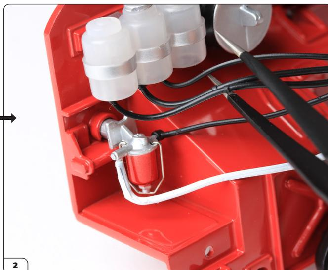
Inserisci il rimanente tubo nero del mazzo nel perno sul lato interno del filtro del carburante.
