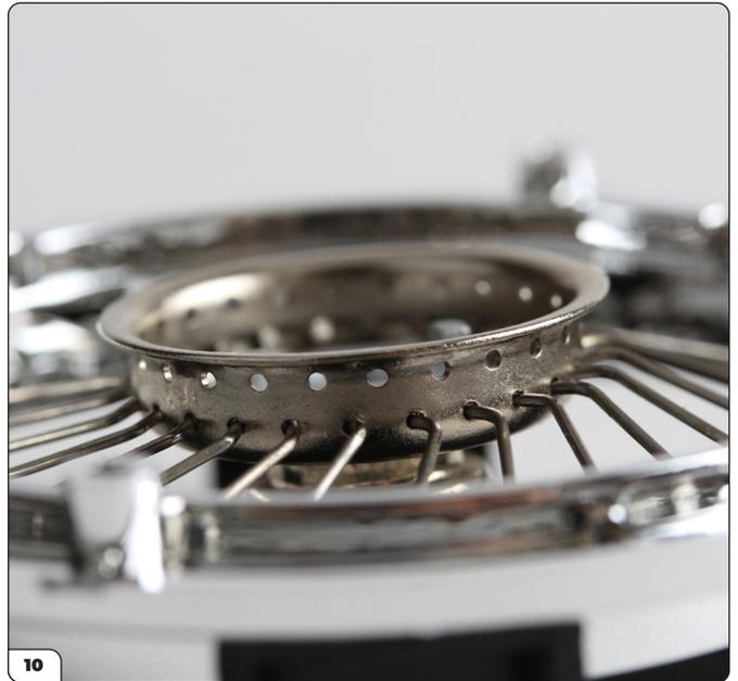
Controlla che tutti i raggi siano stati montati sulla fila più interna del centro della ruota. Successivamente, monterai i raggi sulla fila superiore.
