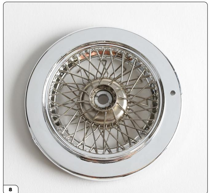
Tutti i 12 raggi di tipo A sono stati montati sulla fila interna.
