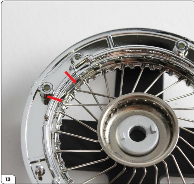
Ripete i passi 11 e 12 per montare il secondo raggio in un foro adiacente al primo raggio sulla fila superiore.
