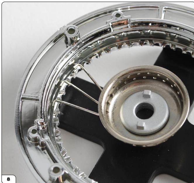
Monta il terzo raggio nello stesso modo e continua per tutto il giro della ruota fino a quando non avrai riempito tutti i fori sulla fila interna del centro della ruota. Controlla che siano agganciati attorno ai denti larghi. Se non sono agganciati attorno a denti larghi, i raggi non si adatteranno e le parti della ruota non si adatteranno insieme alla fine della costruzione.
