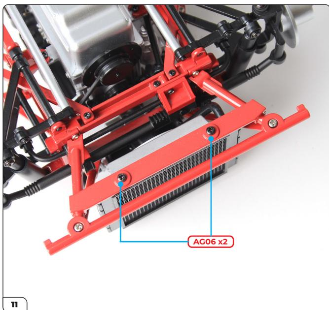
Fissa il radiatore in posizione dal lato inferiore utilizzando 2 viti AG06.
