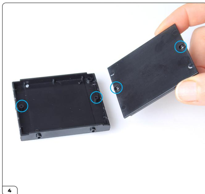
Allinea i due fori sulla sezione posteriore del radiatore con i fori rialzati per le viti sull'assemblaggio radiatore/carena (cerchiati). C'è solo un modo per adattare queste parti. Se non si adattano, ruota il radiatore di 180° e prova di nuovo.
