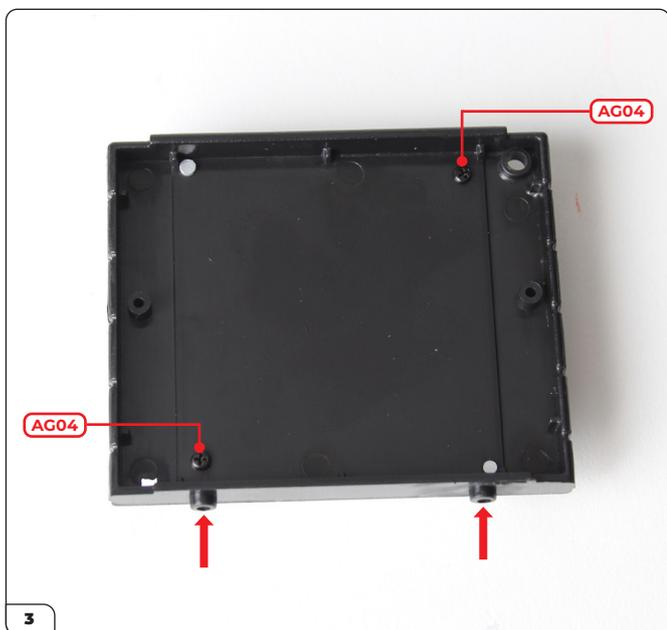
Gira l'assemblaggio radiatore/carena in modo che il lato opposto sia rivolto verso di te e nota che ci sono due sporgenze lungo un bordo (freccie). Fissa la carena al radiatore con 2 viti AG04.
