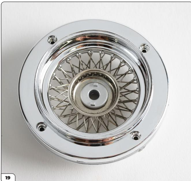
Premi il cerchio interno della ruota in posizione. Controlla che lo spazio tra l'anello di ritenzione del raggio e il cerchio interno si sia chiuso. Se non è così, rimuovi il cerchio interno e ricontrolla la posizione dei raggi, Passo 17.
