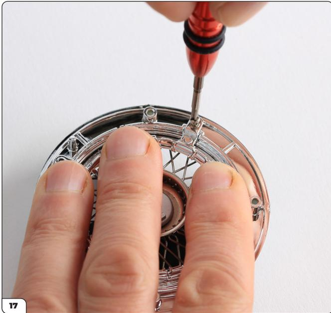
Tieni l'anello di ritenzione in posizione in modo che i raggi siano fissati mentre monti una vite AG02.
