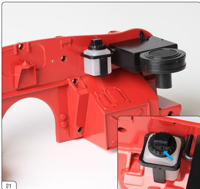
リザーバーブラケットにウォッシャーリザーバーを置きます。ウォッシャーキャップの穴が外側に向くようにをセットします(右下小写真)。
