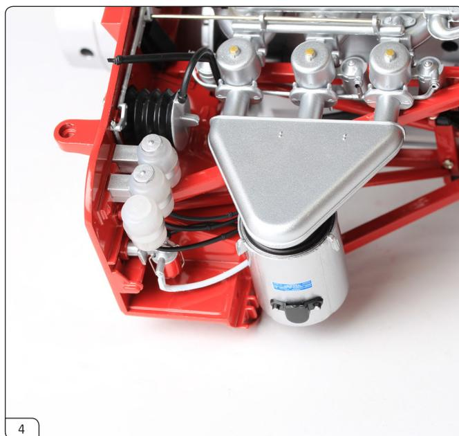
フロントバルクヘッドをサブフレームに合わせます。配管などを挟まないように注意してください。
