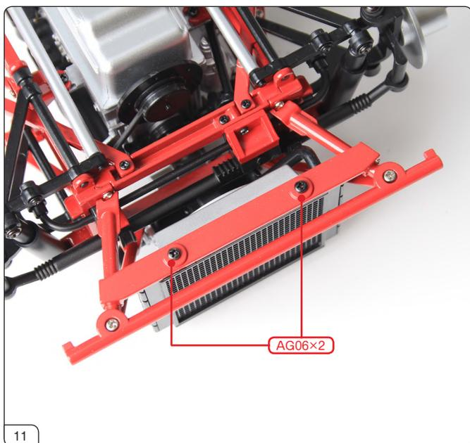
AG06のネジ2本で、下側からラジエターを固定します。
