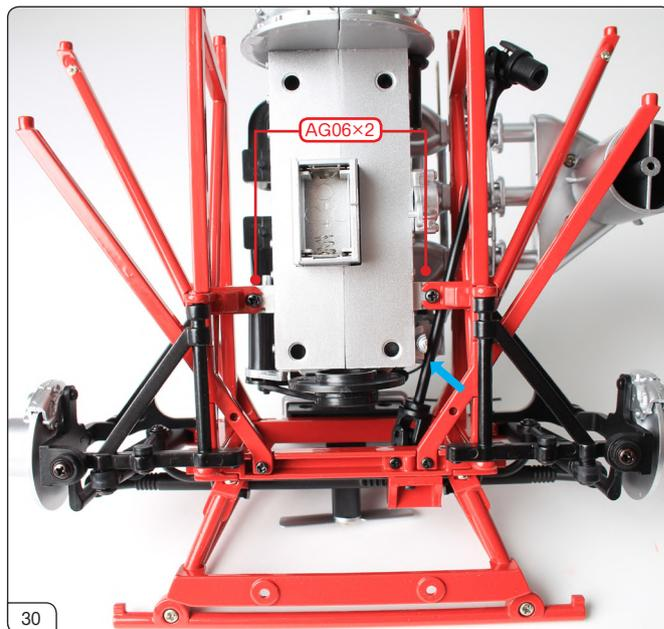
エンジンブロックのマウント部を、写真のようにAG06のネジ2本で固定します。ステアリングコラムは青矢印のように逃がしてください。
