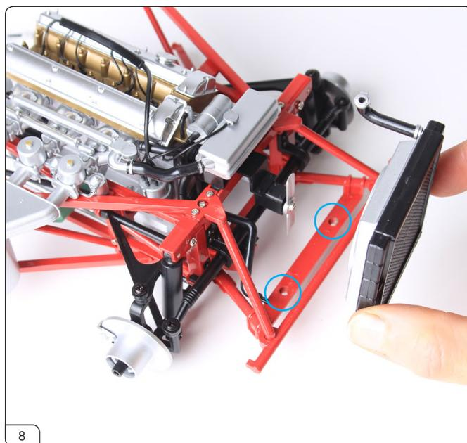
組み立てたラジエターの下部にある2つの突起を、フロントサブフレームベースのボトムバーの2つの穴(青丸印)に合わせます。
