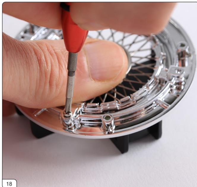
AG02のネジ全部を緩めに締めたあと、スポークにがたつきがないか確かめながら、各ネジを増し締めしていきます。
