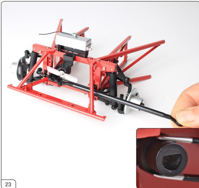
ステアリングラックを、写真のようにサブフレームに通します。車輪がまっすぐ前を向いているとき、ステアリングコラムのD型の平らな面（ピニオンギヤと反対側）が上向きになるように配置します（右下小写真参照）。
