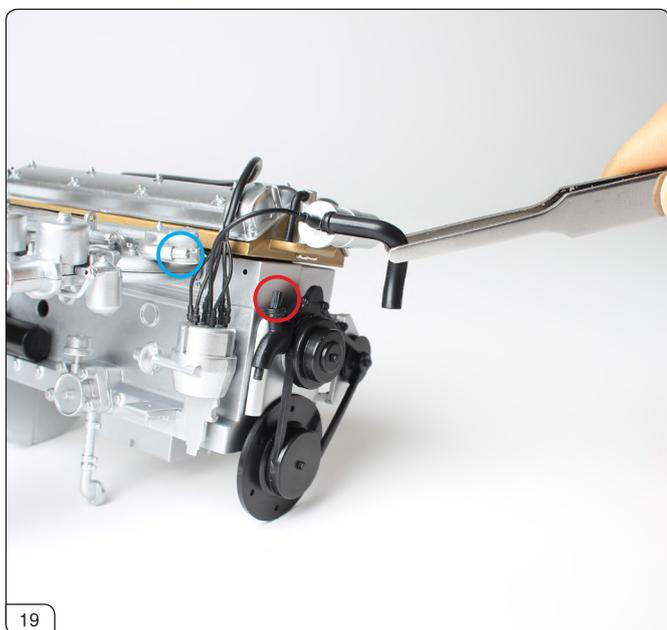
ウォーターホースをウォーターポンプの突起(赤丸印)とエンジンブロックの突起(青丸印)に差し込みます。
