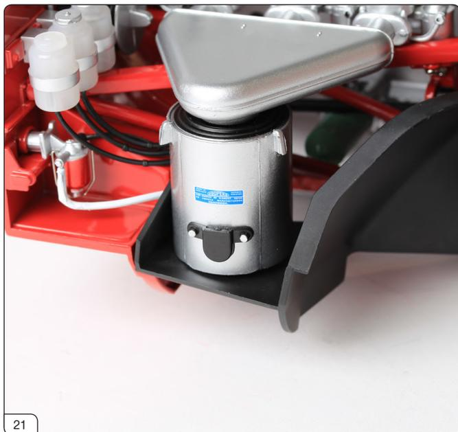
そのままスライドさせて、右マッドシールドのネジ穴をエアフィルター下部の穴に合わせます。
