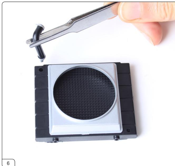
カウルを表に戻して、ホースの突起をラジエター前面の隅にある穴に押し込みます。
