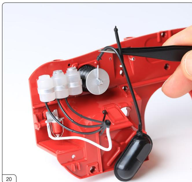
二股になったブレーキバキュームホースの端を、ブレーキサーボユニットの突起に差し込みます。
