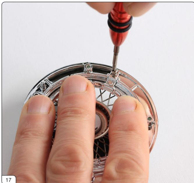
AG02のネジ4本で固定しますが、最初は緩めにネジを締めます。
