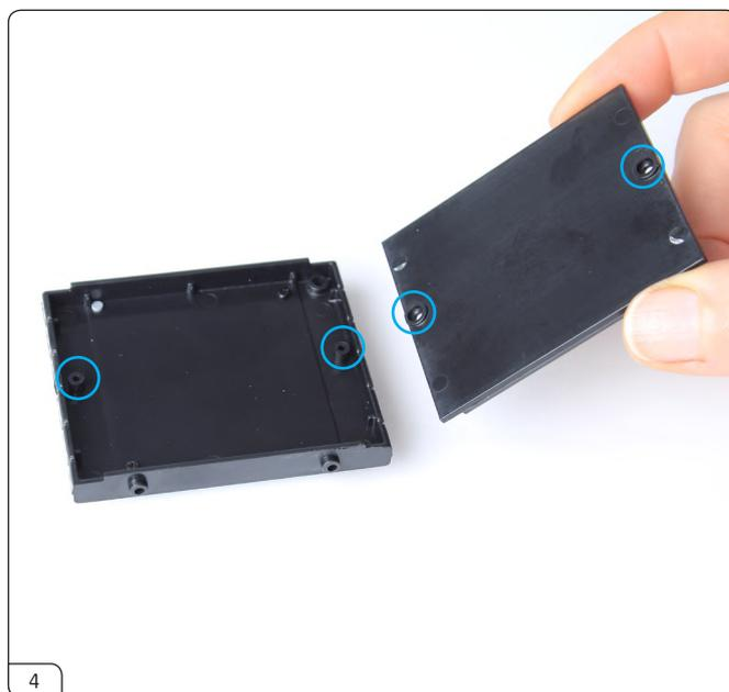
ラジエター背面の2つの穴を、組み合わせたラジエターパーツの穴と合わせます(青丸印)。取り付けの向きは1つしかありません。合わない場合は、ラジエターを180°回転させてください。
