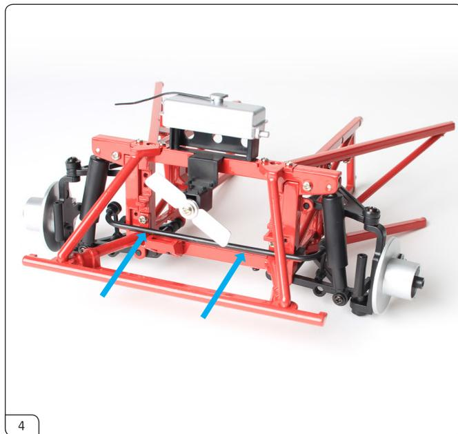
アンチロールバーを写真の青矢印の部分に配置します。
