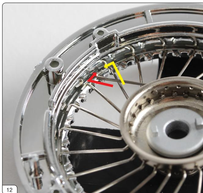
アングルチップを穴に通して「広い歯」に引っ掛けることは同じですが、アングルチップは、内側の穴と逆方向を向きます。黄矢印が内側の穴のスポークで、赤矢印が外側の穴のスポークとなります。
