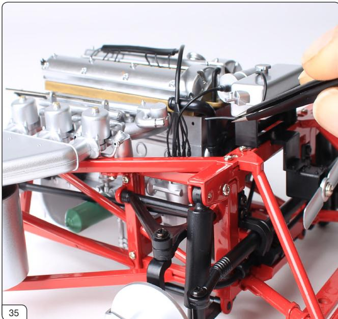
ラジエーターヘッダータンクのフィラーキャップから伸びているホースを、エンジンブロックに取り付けます。
