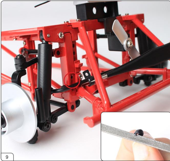
写真のようにアンチロールバーマウントをサブフレームの凹部(赤丸印)にはめ込み、アンチロールバーを保持します。アンチロールバーマウントがうまくはまらなければ、アンチロールバーマウントのプラスチック、もしくは凹部の金属や塗料を少し削ってみましょう。
