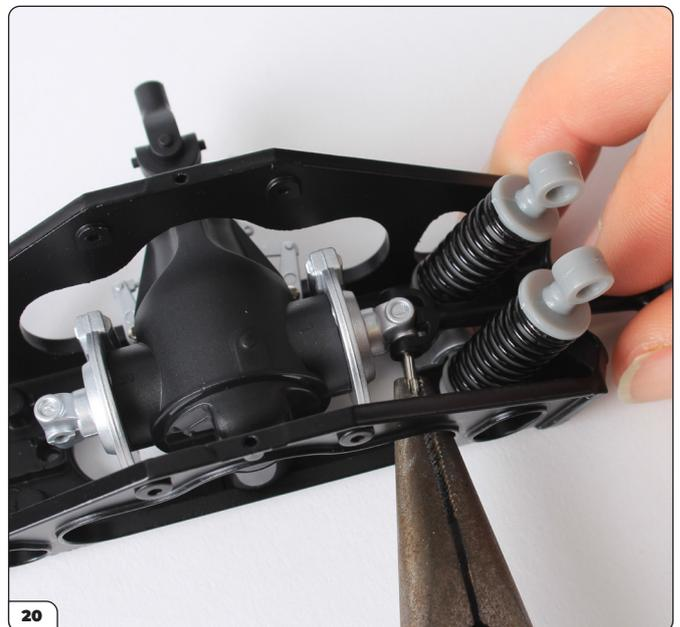
Utilizzando l'apertura sul lato del telaio, inserisci l'estremità liscia del fuso nel semiassi e nel giunto universale.
