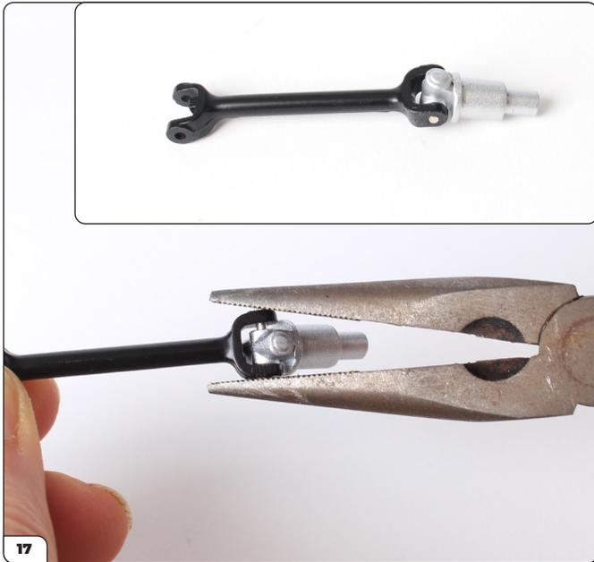
Inserisci l'estremità liscia del fuso attraverso il semiassi e nel giunto universale. Usando delle pinze, premi il fuso in posizione fino a quando le estremità sono a filo su entrambi i lati (inserito).
