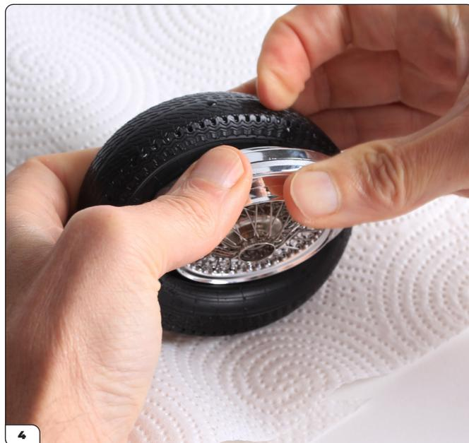
Continua a spingere e tirare, lavorando intorno al pneumatico, fino a quando i lati non si adattano comodamente sopra il bordo della ruota su entrambi i lati.
