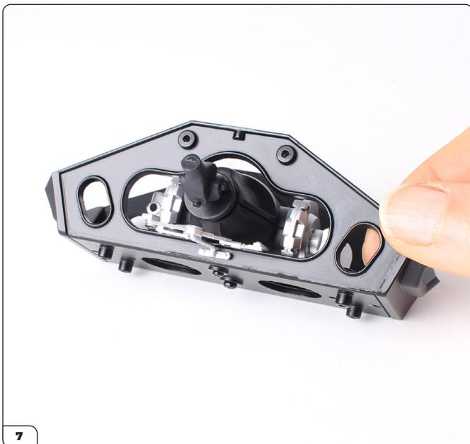
Una volta in posizione, il collegamento del freno a mano dovrebbe avere questo aspetto.
