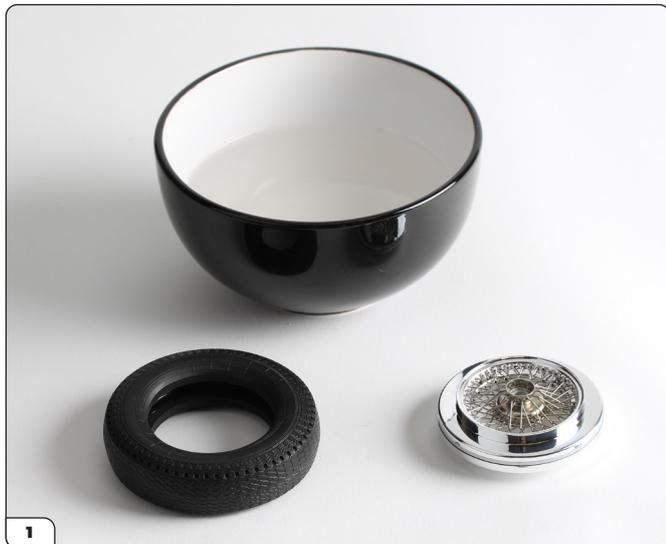
Prendi la ruota completata nella fase 40. Prepara un bagno d'acqua calda riempiendo una piccola ciotola con acqua bollente. Immergi il pneumatico nell'acqua per 2 minuti.
