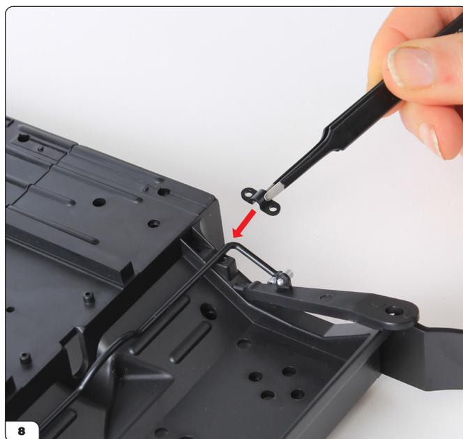
Prendi una delle staffe di montaggio e posizionala sulla barra stabilizzatrice, allineandola con i fori di montaggio.
