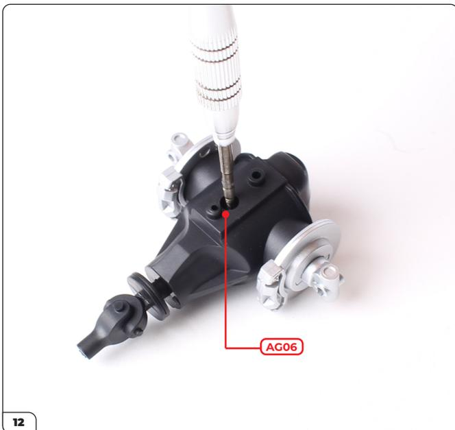
Inserisci una vite di tipo AG06 attraverso il foro nella parte superiore della carcassa per fissare insieme le due metà.
