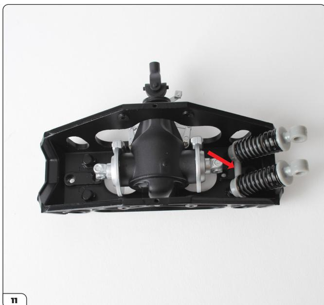
Posiziona l'ammortizzatore nel telaio come mostrato, in modo che la barra sull'ammortizzatore (freccia) sia tra i due fori sulla base del telaio.
