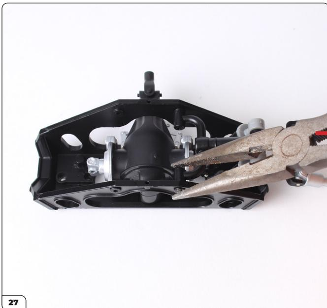
Spremi il fuso in posizione fino a quando non si adatta a filo con il telaio.
