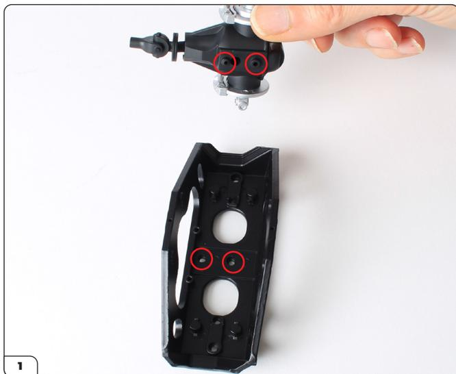
Allinea l'unità di trasmissione della Fase 44 con il telaio posteriore, notando i fori al centro del telaio e i montanti sull'unità di trasmissione (circolati).
