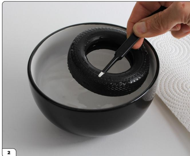
Rimuovi con cura il pneumatico dal bagno d'acqua usando delle pinze o delle mollette - il pneumatico sarà molto caldo! Scuoti per eliminare l'acqua in eccesso e tampona con della carta da cucina o un asciugamano.
