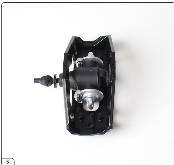
L'unità di trasmissione dovrebbe sporgere attraverso l'apertura nel telaio con i montanti che si adattano nei fori per le viti indicate nella foto 1.
