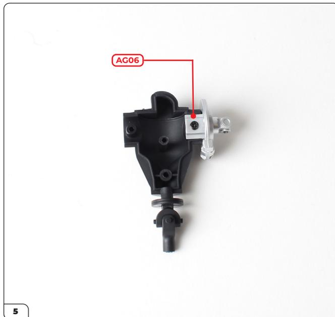
Fissalo in posizione utilizzando una vite di tipo AG06.
