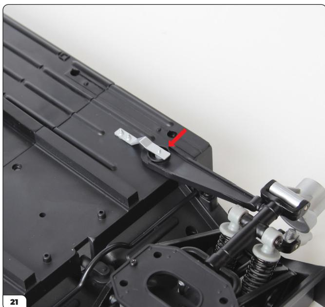
Nell'orientamento mostrato, infila un'estremità di una delle cinghie di sicurezza nel foro del braccio del raggio e l'altra estremità nel pannello del pavimento.
