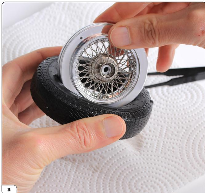
Lavorando rapidamente mentre il pneumatico è malleabile, spingi la ruota nel pneumatico e ruota per adattare il bordo esterno della ruota sotto il bordo interno del pneumatico.
