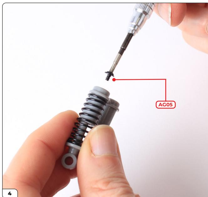
Tenendo insieme l'ammortizzatore, prendi una vite di tipo AG05 e inseriscila alla fine dell'asta del corpo dell'ammortizzatore.
