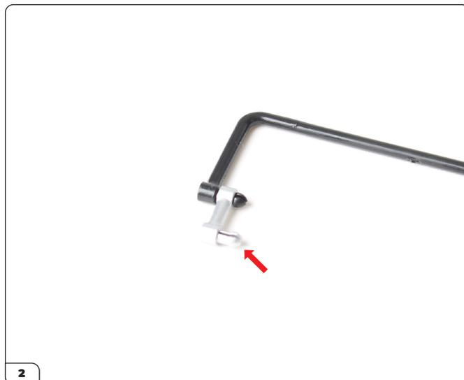
Spingi il collegamento in uno dei perni della barra stabilizzatrice, assicurandoti che il perno sul collegamento sia rivolto verso l'interno (freccia).
