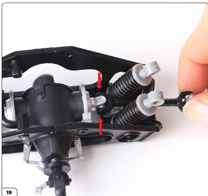
Monta il semiassi in modo che i fori si allineino con i fori del giunto universale dell'unità di trasmissione finale (freccie).
