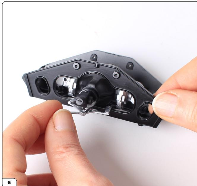
Premi il perno in posizione, inserendo i due bracci del collegamento del freno a mano nell'apertura del telaio.
