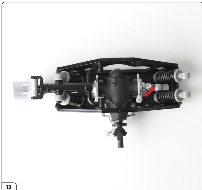
Posiziona la piastra di montaggio nei fori sulla base del telaio in modo che la sezione curva copra la barra sull'ammortizzatore (freccia).
