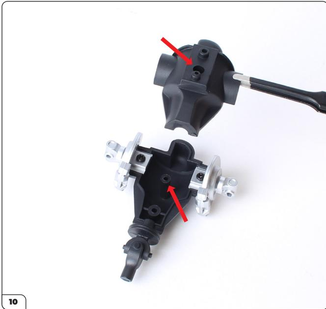
Prendi la carcassa superiore e montala sulla carcassa inferiore, allineando il pilastro centrale sulla metà inferiore con il foro della metà superiore (freccie).
