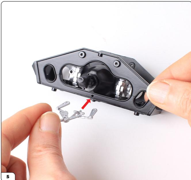
Prendi il collegamento del freno a mano e allinealo con il telaio. Nota il perno di posizionamento sul collegamento del freno a mano che si inserirà nel foro sul telaio (freccia).
