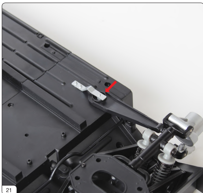
21 写真のように安全ストラップの一方の端をラジアスアームの穴に通し (赤矢印)、もう一方をフロアパネルにはめ込みます。
