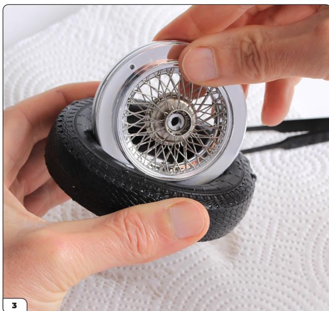
Lavorando in fretta mentre il pneumatico è malleabile, spingi la ruota nel pneumatico e ruota per adattare il cerchio esterno della ruota sotto il bordo interno del pneumatico.
