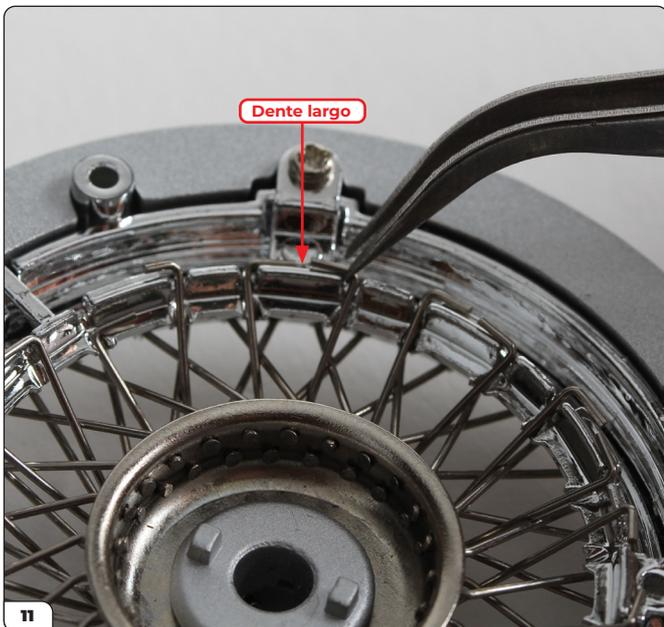
Quando monti il primo raggio di tipo B, infilalo attraverso un'apertura vuota a forma di diamante (vedi passo 12) e controlla che si aggancerà attorno a un dente largo sul lato opposto come mostrato qui.
