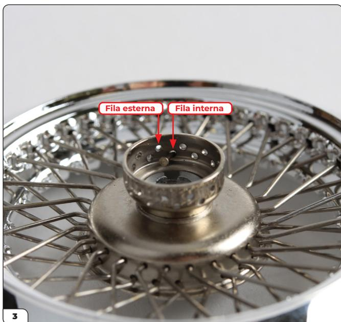
Gira la ruota in modo che il lato più piccolo del centro della ruota sia rivolto verso di te. Nota che ci sono due file per infilare i raggi: una fila interna e una fila esterna. Inizierai con la fila interna.
