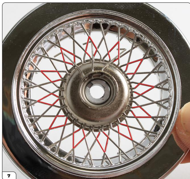
Continua a infilare i raggi di tipo A tutto intorno alla fila interna, spingendo la punta attraverso aperture a forma di diamante alternate come indicato.
