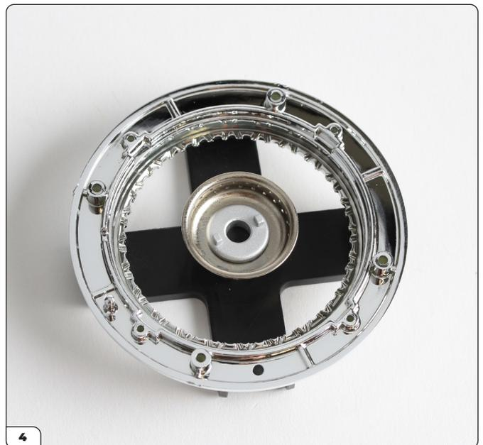
Monta il cerchione della ruota sul gabarit, premendo fermamente per bloccare il cerchione in posizione.
