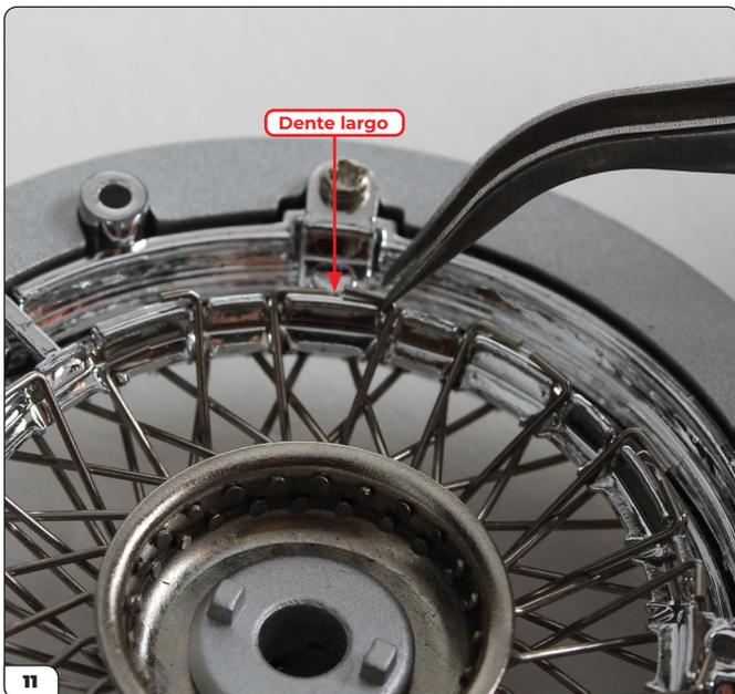
Quando monti il primo raggio di tipo B, infilalo attraverso un'apertura a forma di diamante vuota (vedi passaggio 12) e controlla che si agganci attorno a un dente largo sul lato opposto come mostrato qui.
