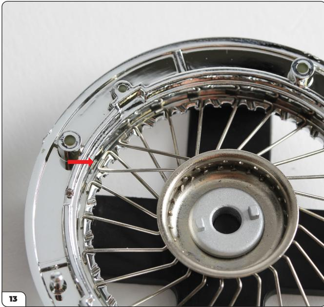
Ripeti i passi 11 & 12 per inserire il secondo raggio in un foro adiacente al primo raggio sulla fila superiore.
