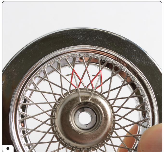
Una volta che sei sicuro che il primo raggio sia montato correttamente, infila il raggio successivo attraverso un buco adiacente nella fila inferiore, ma questa volta, fai passare attraverso il buco a forma di diamante che è il secondo in fila.
