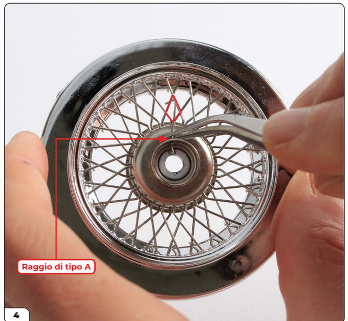
Usando delle pinzette, infila un raggio di tipo A attraverso un foro sulla fila interna. Dirigi la punta del raggio attraverso l'apertura a forma di diamante leggermente in senso orario (colorato di rosso sopra) in modo che la punta spunti sul lato opposto.
