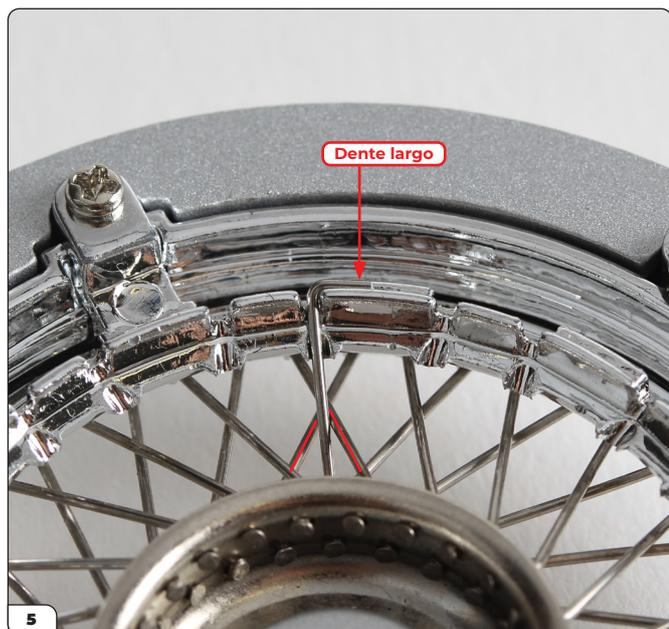
Gira la ruota e controlla che la punta si agganci a un dente largo sul lato opposto. Se non si adatta a un dente largo, ricomincia, infilando il raggio attraverso il prossimo foro a forma di diamante.
