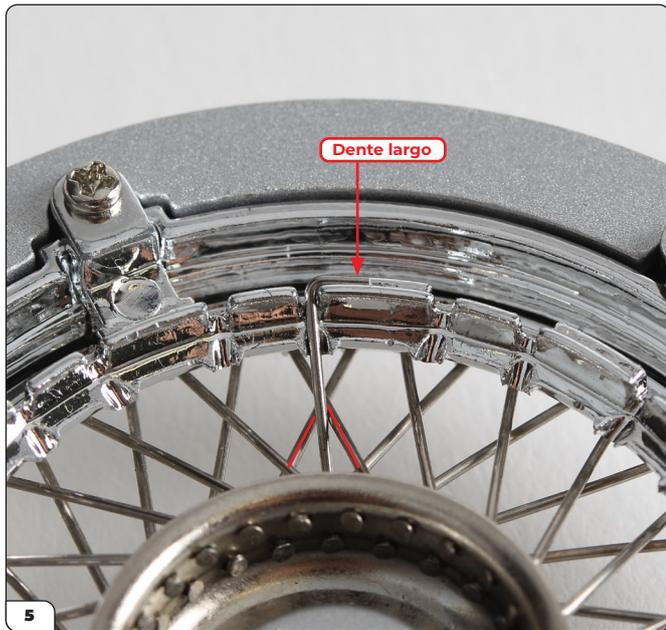
Gira la ruota e controlla che la punta possa agganciarsi a un dente largo sul lato opposto. Se non si adatta a un dente largo, ricomincia, infilando il raggio attraverso il successivo buco a forma di diamante.
