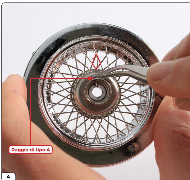
Utilizzando delle pinzette, infila un raggio di tipo A attraverso un buco sulla fila interna. Indirizza la punta del raggio attraverso l'apertura a forma di diamante leggermente in senso orario (colorato in rosso sopra) in modo che la punta spunti sul lato opposto.
