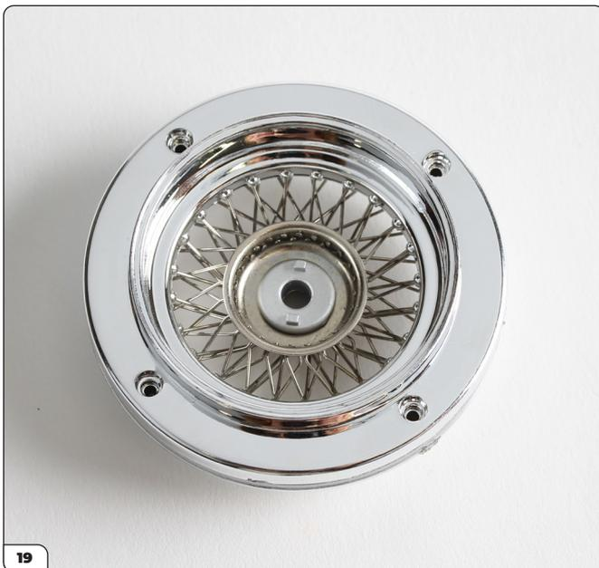
Premi il cerchio interno della ruota in posizione. Controlla che lo spazio tra l'anello di ritenuta del raggio e il cerchio interno sia chiuso. Se non lo è, rimuovi il cerchio interno e ricontrolla la posizione dei raggi, Passo 17.
