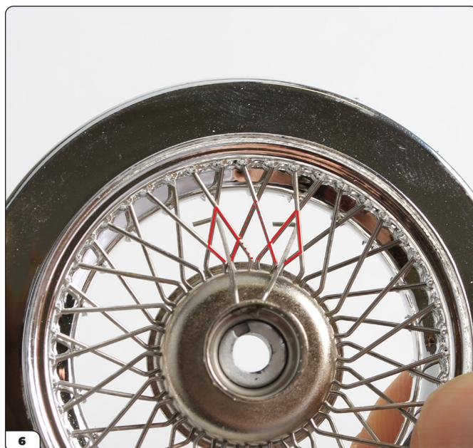
Una volta che sei sicuro che il primo raggio sia montato correttamente, infila il raggio successivo attraverso un foro adiacente nella fila inferiore, ma questa volta, infilalo nel foro a forma di diamante che si trova due posizioni oltre.
