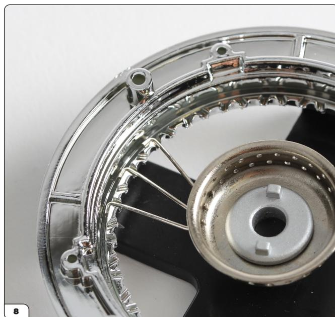
Monta il terzo raggio allo stesso modo, e prosegui tutto intorno alla ruota fino a quando non hai riempito tutti i fori nella fila interna del centro della ruota. Controlla che siano agganciati attorno ai denti larghi. Se non sono agganciati attorno ai denti larghi, i raggi non si adatteranno e le parti della ruota non si adatteranno insieme alla fine della costruzione.
