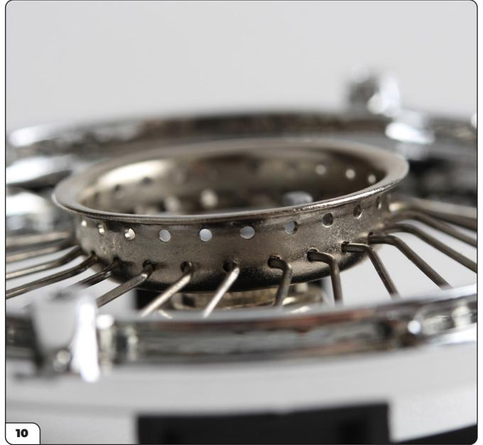
Controlla che tutti i raggi siano stati montati nella fila più interna del centro della ruota. Successivamente, monterai i raggi nella fila superiore.
