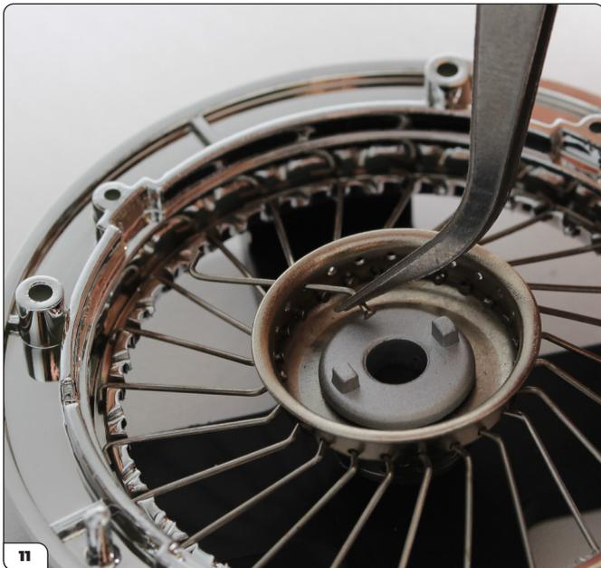
Inizia allo stesso modo, infilando la punta di un raggio attraverso un foro nella fila superiore.
