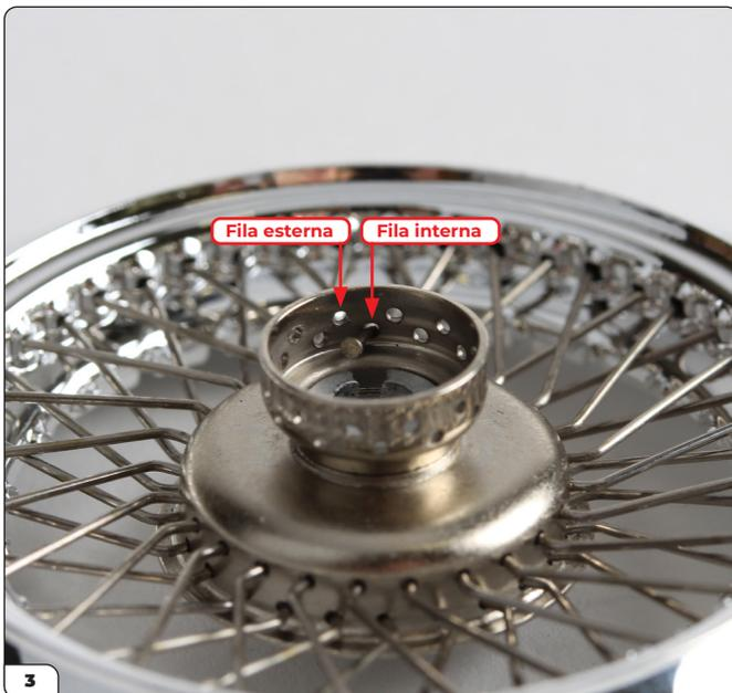
Gira la ruota in modo che il lato più piccolo del centro della ruota sia rivolto verso di te. Nota che ci sono due file per infilare i raggi - una fila interna e una fila esterna. Inizierai sulla fila interna.
