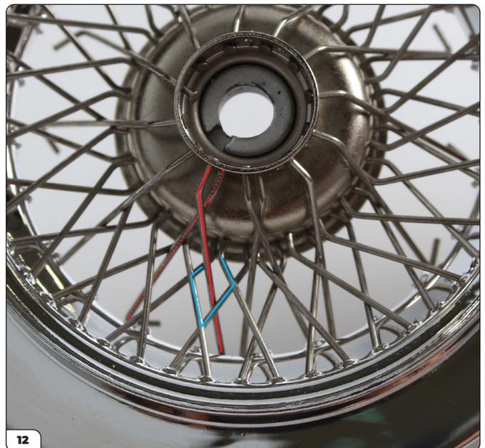
Quando infili il raggio di tipo B attraverso il lato opposto, dovrebbe incrociare un raggio di tipo A e passare attraverso un'apertura vuota a forma di diamante. Dovrebbe portare leggermente in senso antiorario. Controlla che si aggancerà a un dente largo, ma non agganciarlo ancora, lascia i raggi allentati.
