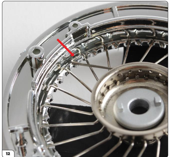
Le punte dei raggi ora saranno rivolte nella direzione opposta rispetto a quelle montate sulla fila inferiore. Assicurati che siano agganciate attorno a un 'dente largo', altrimenti non possono essere fissate in posizione in un passo successivo.
