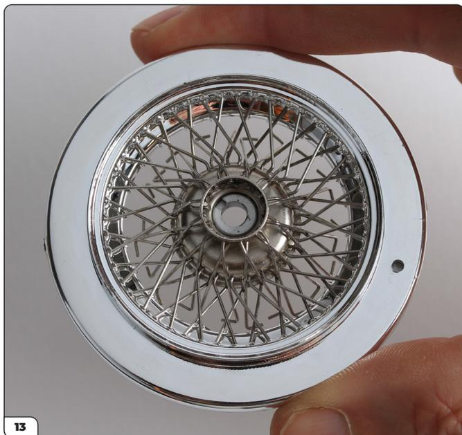
Continua ad infilare i raggi di tipo B tutto intorno alla fila esterna, spingendo il raggio attraverso le aperture a forma di diamante alternate. Questa immagine mostra che tutti i 12 raggi di tipo B sono stati montati sulla fila esterna del centro della ruota e sono rimasti allentati sul lato inferiore.
