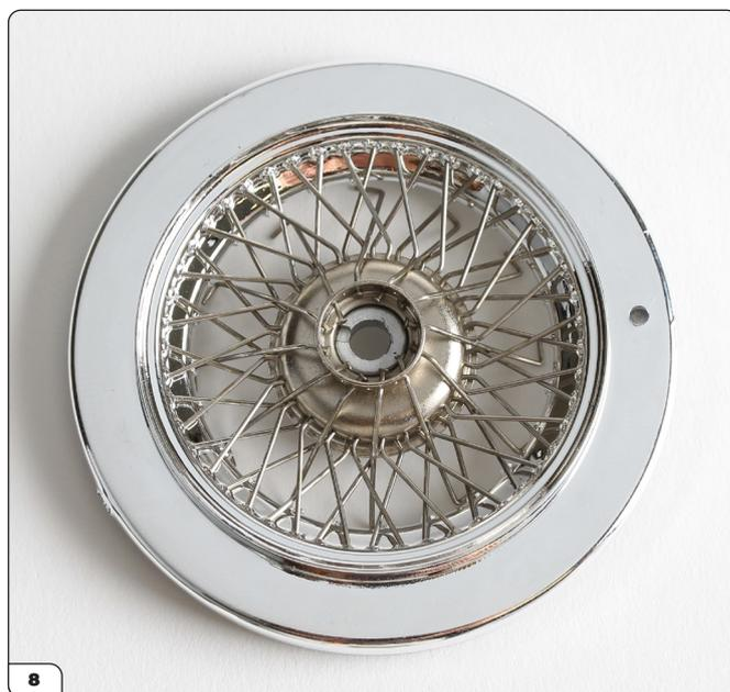
Tutti i 12 raggi di tipo A sono stati montati nella fila interna.
