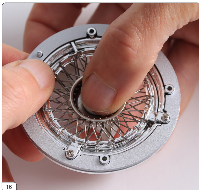
コットンないしキッチンペーパーで、しっかりと押さえながらスポークタイプAとスポークタイプBのアングルチップを「広い歯」にセットしていきます。親指でなでるように押さえたり、ピンセットも使ってみてください。
