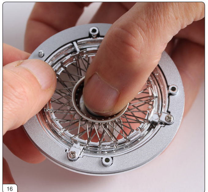
コットンないしキッチンペーパーで、しっかりと押さえながらスポークタイプAとスポークタイプBのアングルチップを「広い歯」にセットしていきます。親指でなでるように押さえたり、ピンセットも使ってみてください。
