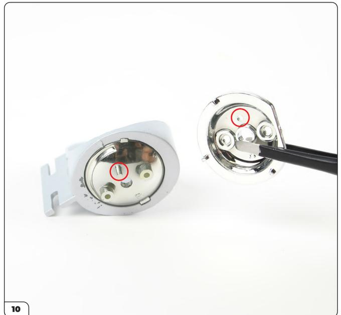
Prendi il supporto del faro destro e allinealo con l'assemblaggio della presa del faro destro come mostrato. Nota il perno sul faro e il piccolo foro sul supporto (cerchiati).
