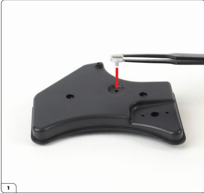
Allinea il pin sul mittente del serbatoio di carburante con il foro nel mezzo della parte superiore del serbatoio di carburante.
