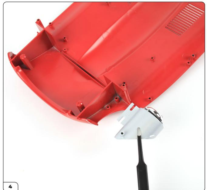
Ora prendete il cofano dalla Fase 23 e posatelo con cura a testa in giù sulla vostra superficie di lavoro. Allineate l'assemblaggio del faro destro dalla fase precedente con il cofano come mostrato.
