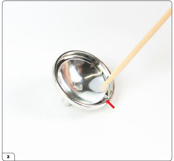
Applicare con cura una piccola quantità di colla PVA nell'incavo (freccia) situato sul bordo del riflettore.
