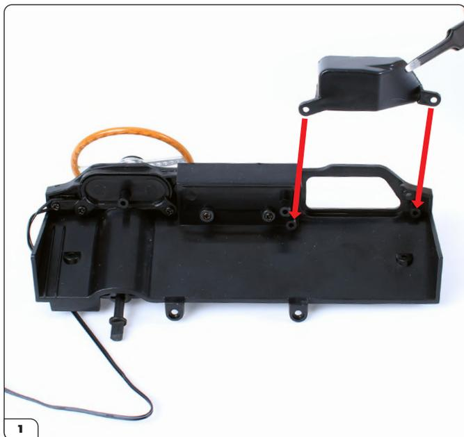
Prendi l'assemblaggio del cruscotto dalla Fase 64. Allinea il vano portaoggetti con il cruscotto come mostrato e fissalo in posizione usando i fori per le viti come guida (freccie).
