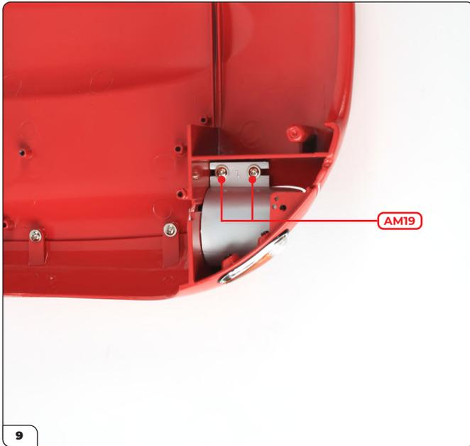
Con l'ala anteriore fissata in posizione, inserisci 2 viti AM19 nell'assemblaggio del faro per fissarlo.
