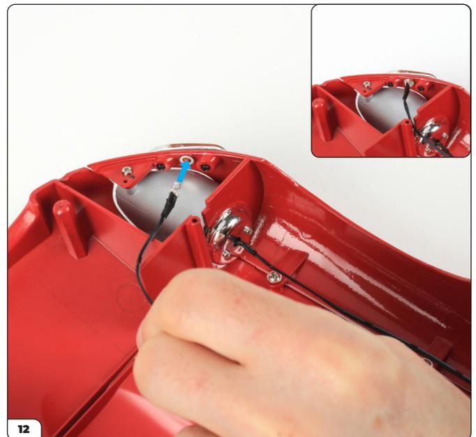
Infine prendi il LED dell'indicatore di sinistra (marcato '7') fornito in questa fase e allinealo con il foro sul retro del gruppo luce di posizione/indicatore (freccia). Spingi la lampadina del LED nel foro finché non è saldamente in posizione (riquadro).
