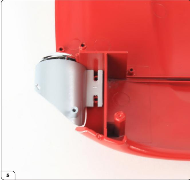
Posiziona l'assemblaggio del faro in modo che i fori per le viti dal cofano siano allineati con le tacche come mostrato.
