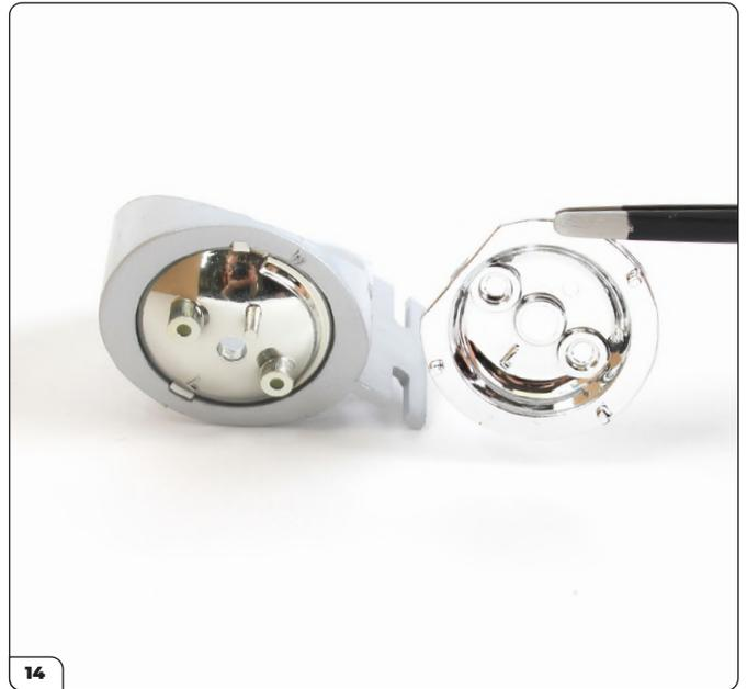
Allinea il supporto con il retro della presa del faro. Montalo in posizione in modo che il perno si inserisca nel foro e i fori delle viti si allineino.
