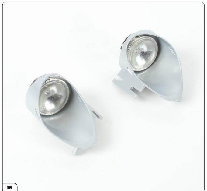
I due assemblaggi dei fari dovrebbero apparire così una volta completati.
