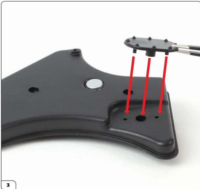
Successivamente prendi la pompa del carburante e allineala con i fori corrispondenti nella parte superiore del serbatoio del carburante.
