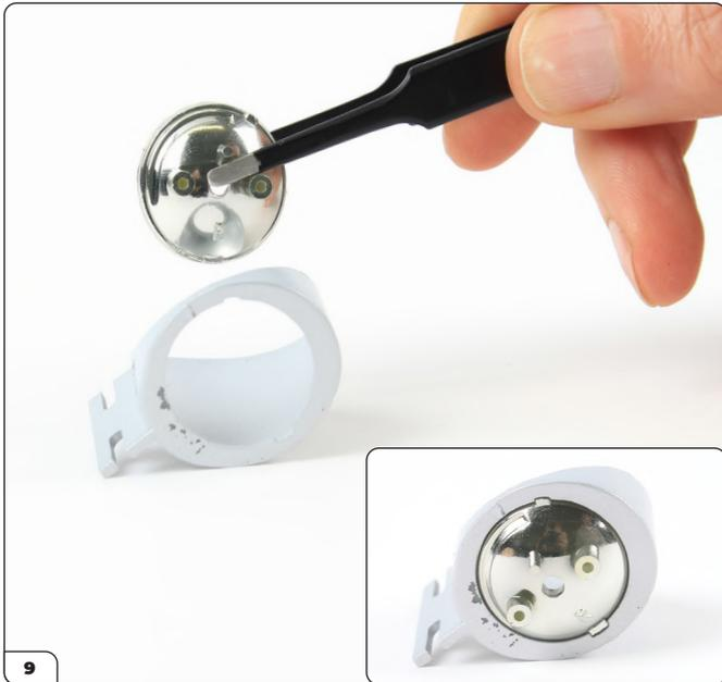
Iniziando con le parti destre, premi il faro assemblato nelle fasi precedenti nella presa del faro in modo che le due linguette del faro si inseriscano nelle due tacche della presa. L'immagine in alto mostra il faro montato in posizione.
