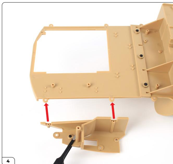
Ora prendi l'assemblaggio dell'abitacolo dalla Fase 67. Allinea il passaruota posteriore sinistro con il pavimento posteriore come mostrato. Montalo in posizione in modo che i fori per le viti siano allineati (freccie).
