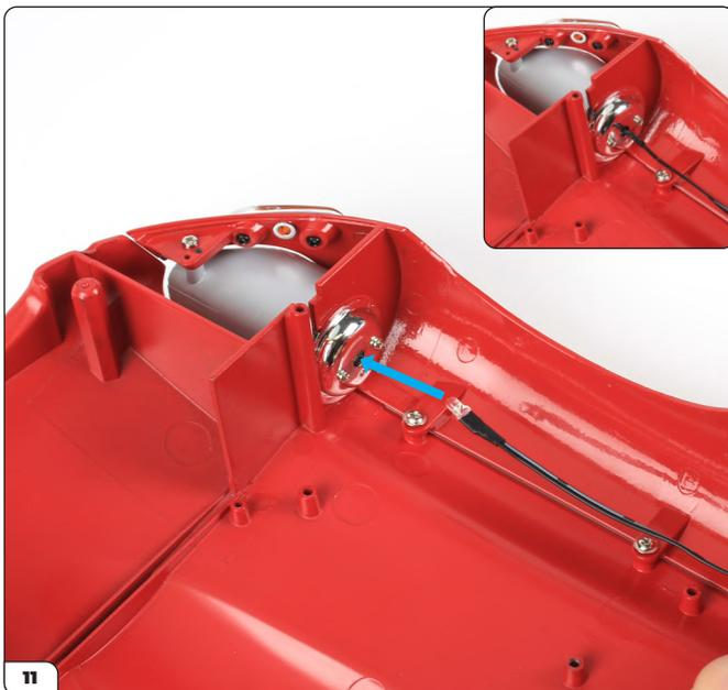
Ora prendi il LED del faro sinistro (marcato '5') fornito nella fase 71 e allinealo con il foro sul retro del faro (freccia). Spingi la lampadina del LED nel foro finché non è saldamente in posizione (riquadro).
