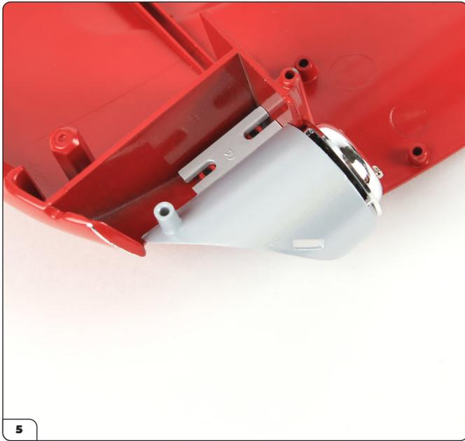
Posizionare l'assemblaggio del faro in modo che i fori per le viti dal cofano siano allineati con le tacche come mostrato.
